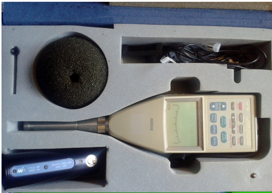
Figura 2.6. Sonómetro integrador de clase 1 Modelo Rion NL-14 y calibrador Norsonic Tipo 1251 clase 1, empleados en las distintas medidas realizadas durante el tratamiento educativo. (Fuente: Elaboración propia).
