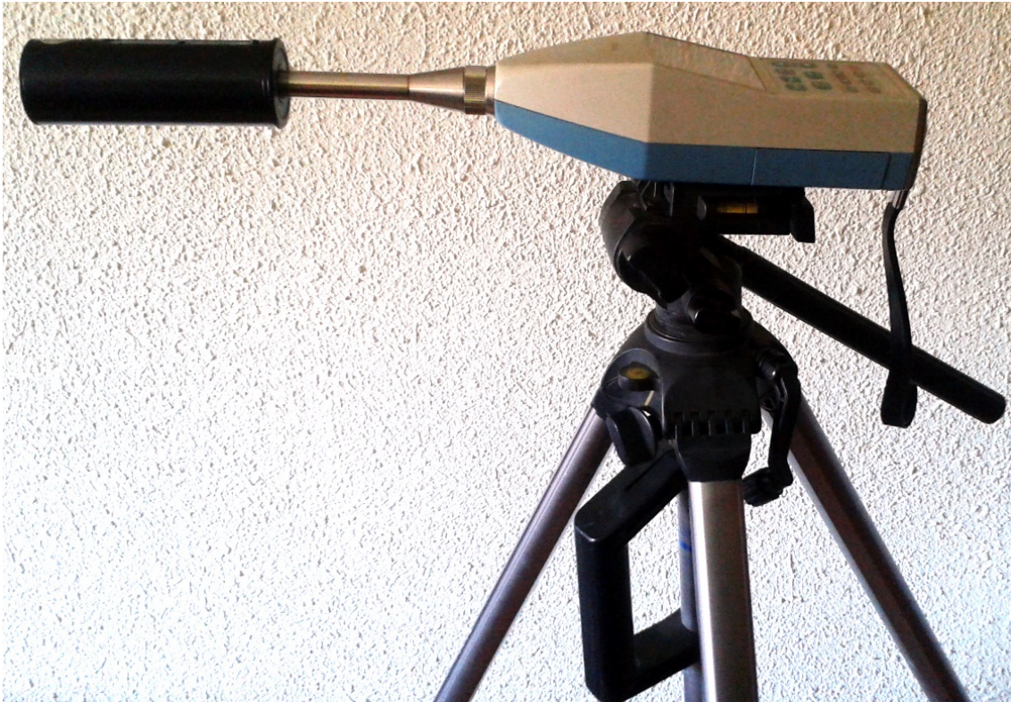
Figura 4.4. Sonómetro integrado Rion NL-14, calibrador acústico Norsonic y trípode empleados en las medidas de ruido realizadas en los institutos. (Fuente: Elaboración propia).
