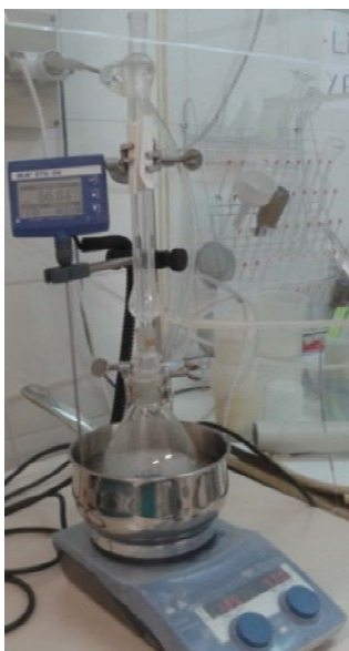
Figura 2.4 Dispositivo experimental empleado para realizar los intercambios H^+/Li^+ en muestras de Li_7La_3Zr_2O_{12} en polvo.
