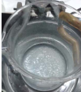
Figura 2.1 Formación del gel durante el proceso de calentamiento a 135 °C.
