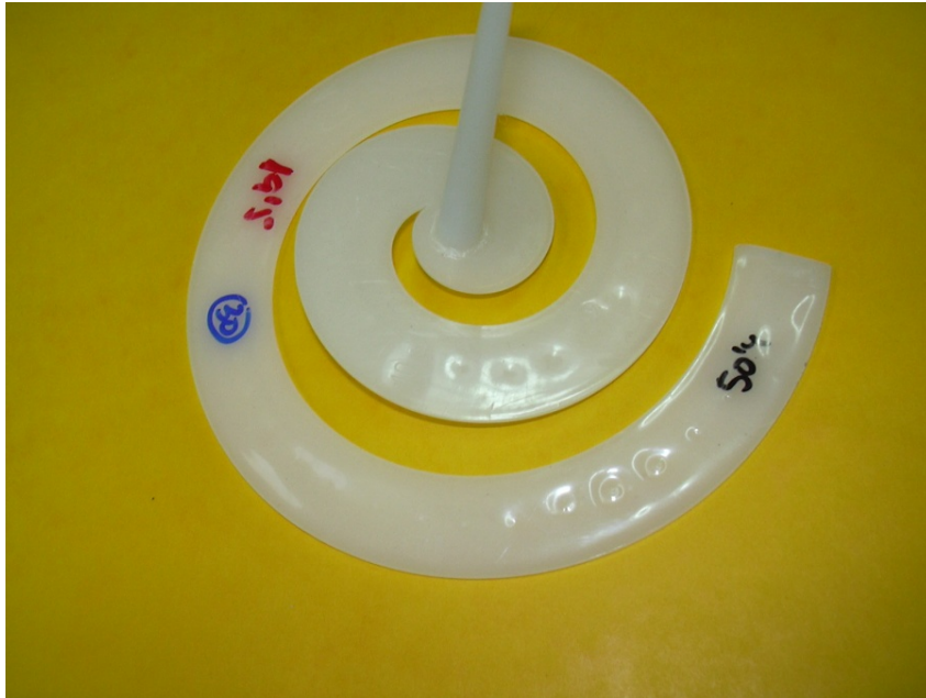
Fig. 6.11. Rechupes que aparecen en espirales
