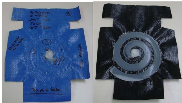
Figura 9.2. Inyección de espiral sobre folio plástico trenzado barnizado de mayor espesor
