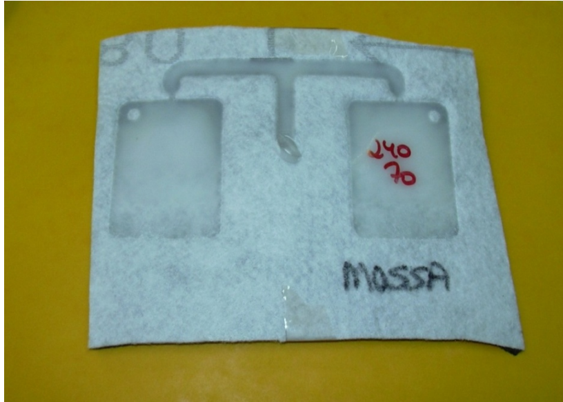
Fig. 6.28 Pletinas inyectadas sobre Mosa
