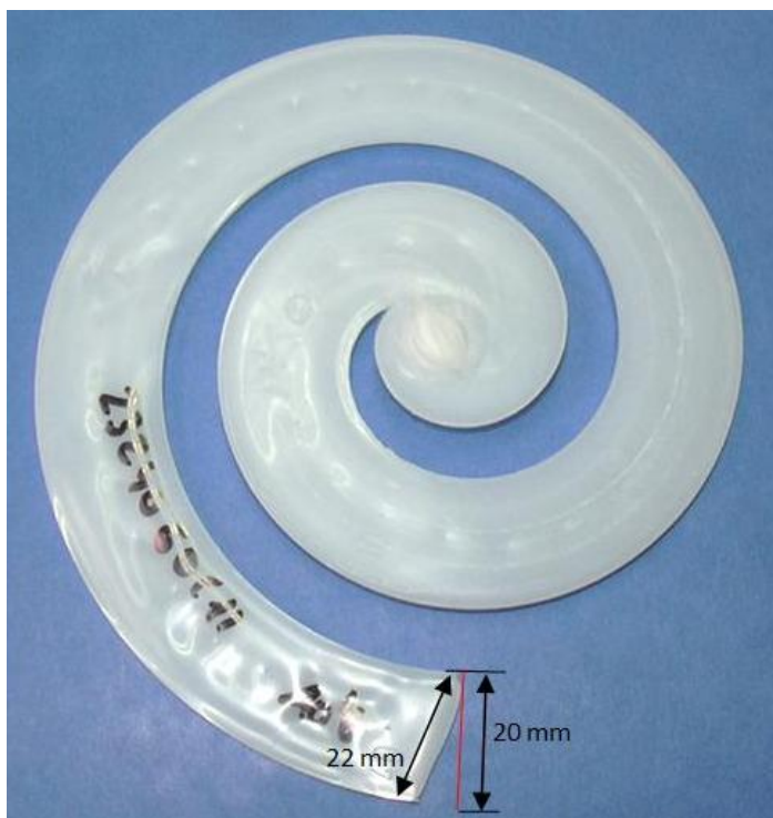
Fig. 4.14. Forma del frente de flujo de la espiral
