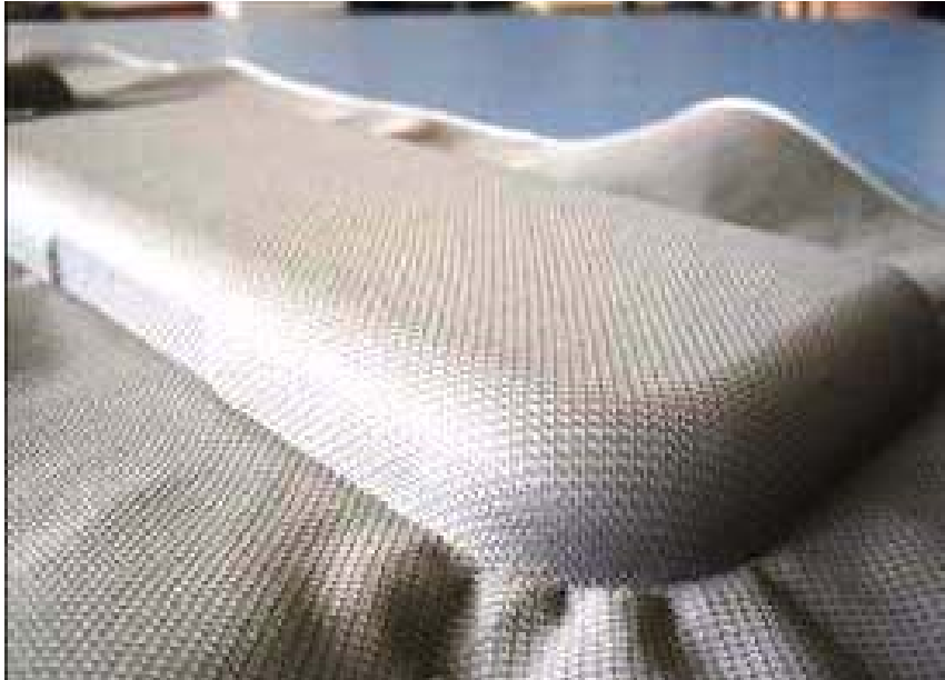
Figura 2.4 Pieza inyectadas con textil, tras ser extraídas del molde
