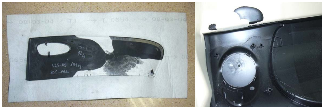
Figura 9.8. Traspaso en piezas de gran tamaño inyectadas sobre textil y TPO respectivamente
