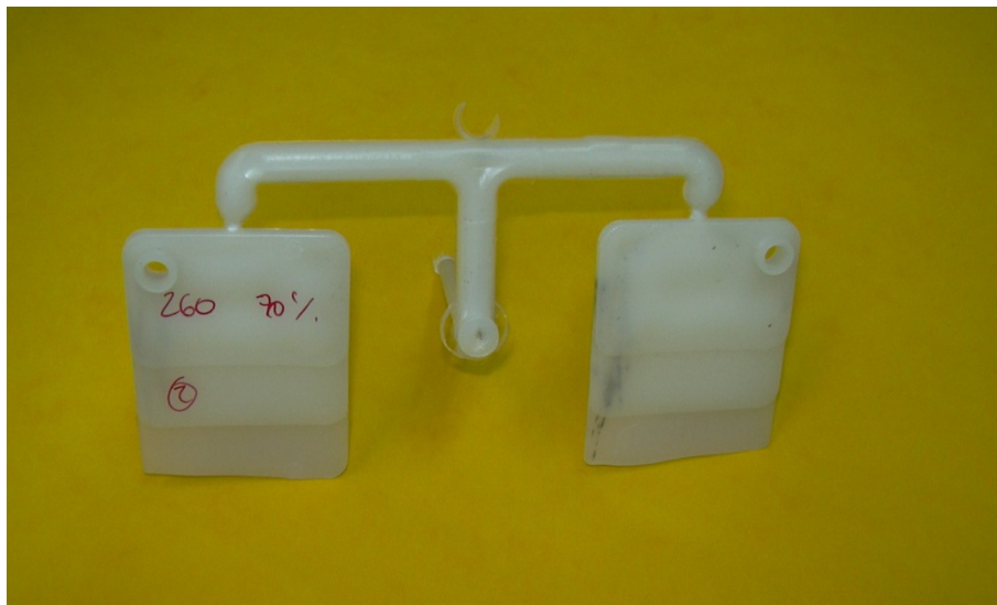
Fig. 4.21 Molde de las pletinas y pieza que sale de él
