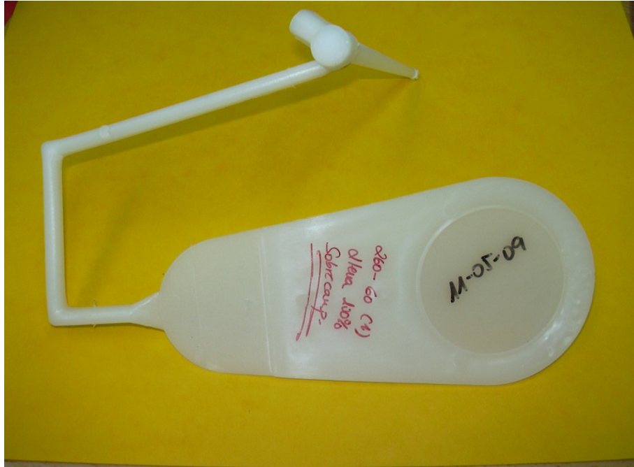
Fig. 4.22 Molde de las probetas y pieza que sale de él
