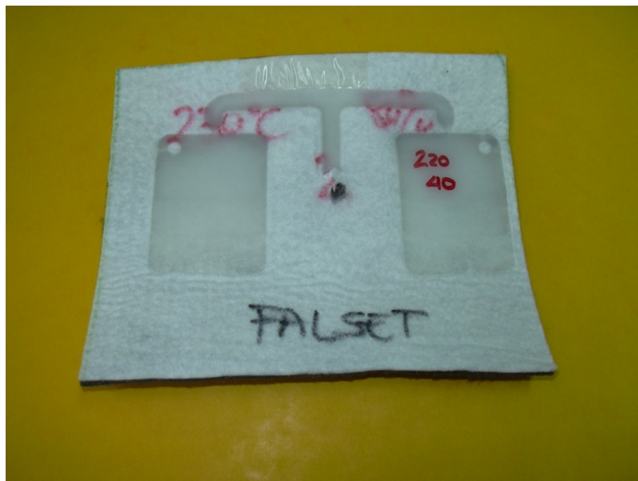
Fig. 6.39 Pletinas inyectadas sobre FALSET
