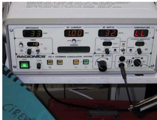
Figura 4.1.5.2.1: Fuente de radiofrecuencia
