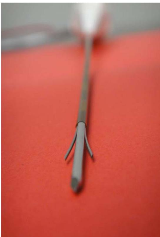
Figura 4.1.5.3.4: Electrodo híbrido utilizado en nuestro estudio. Consiste en un sistema de enfriamiento interno (similar al cool-tip) y dos tubos expansibles (14-gauge), a 2 mm de la aguja, por los que difunde suero salino a 6 ml/h (arriba esquema del electrodo, en fase de fabricación, abajo, electrodo híbrido utilizado en estudio experimental).
