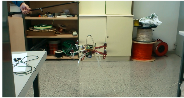
Figura 6.4: Montaje realizado para probar el funcionamiento del control de altura.
