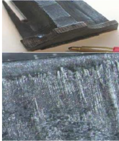
Figura 43 Efectos de la abrasión en matrices de extrusión [11].
