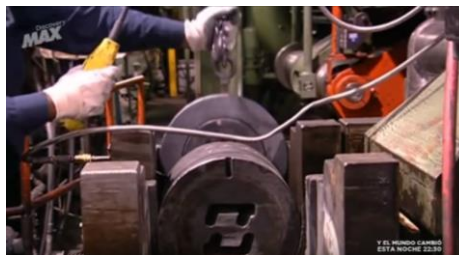
Figura 151. Montaje de la matriz sobre utensilio.
