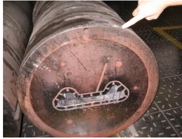
Figura 38 Muestra de un bolster con el circuito de refrigeración.
