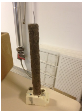
Figura VI.7. Montaje para la “probeta armada”
