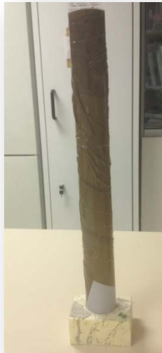
Figura VI.2. Molde final empleado para la fabricación de las probetas
