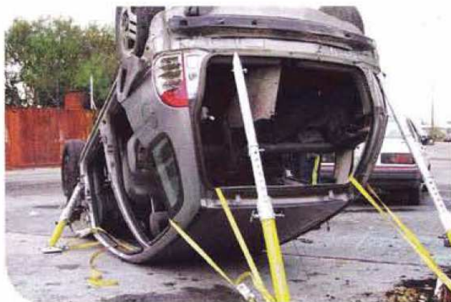
Figura M5. Uso de puntales para la estabilización en vuelco total
