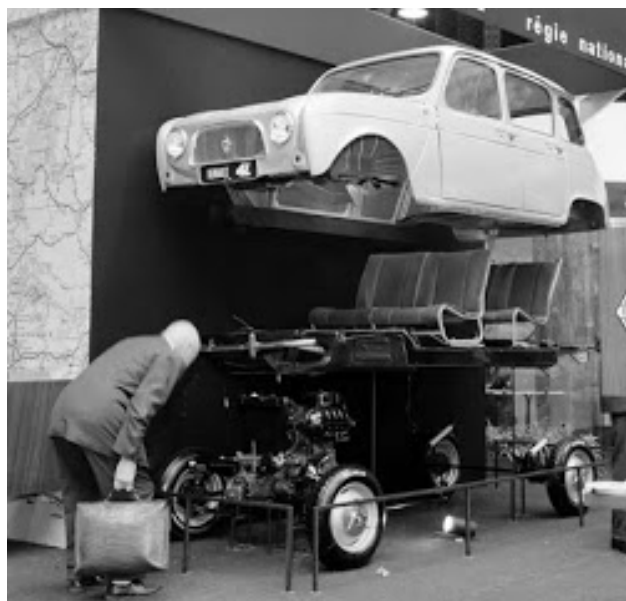
Figura AI2. Diferentes partes que componen el Renault 4L
