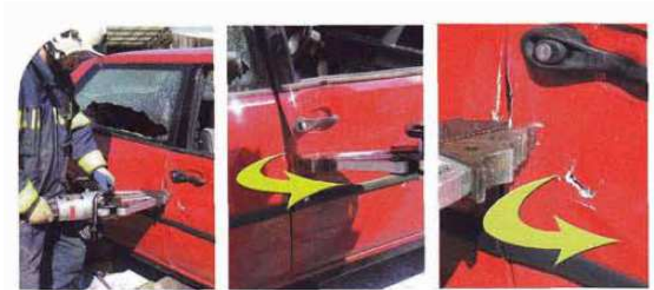
Figura AIII11. Apertura de huecos mediante la “técnica del pellizco”
