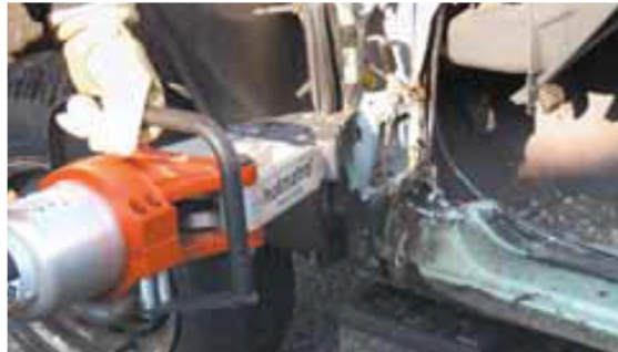
Figura AIII38. Abatimiento del área entre ambos cortes
