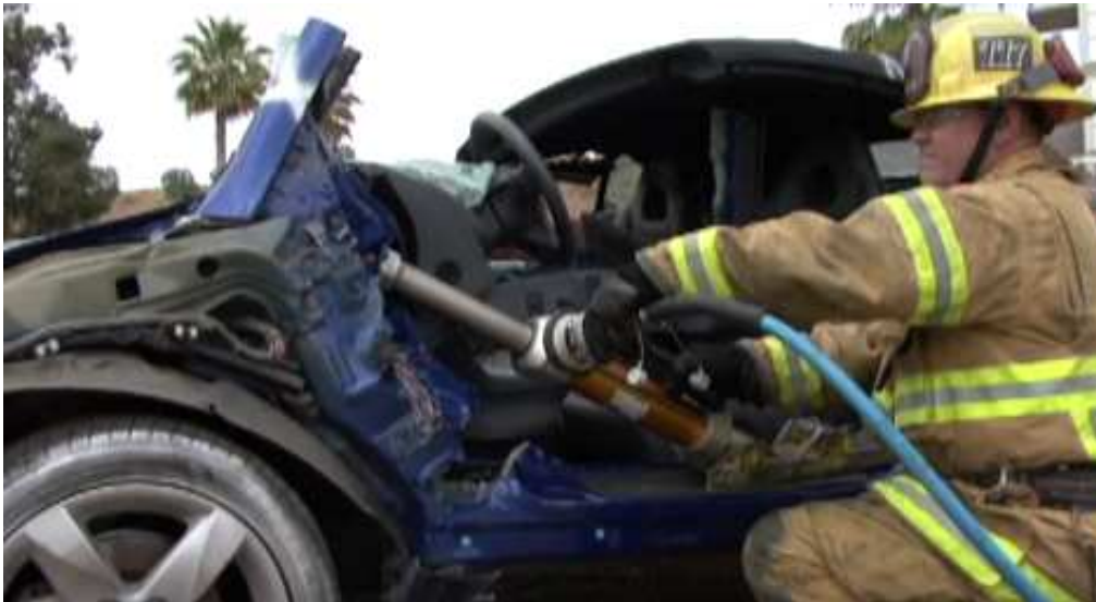
Figura AIV5. Técnica “Modified Dash Roll”
