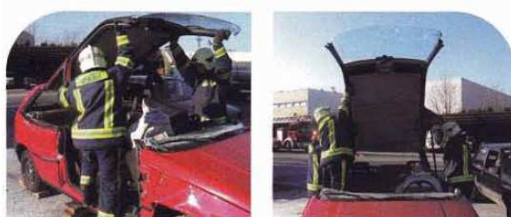
Figura AIII21. Abatimiento trasero del techo
