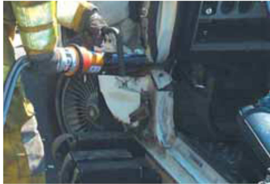
Figura AIII39. Área de inserción en la parte media del poste A
