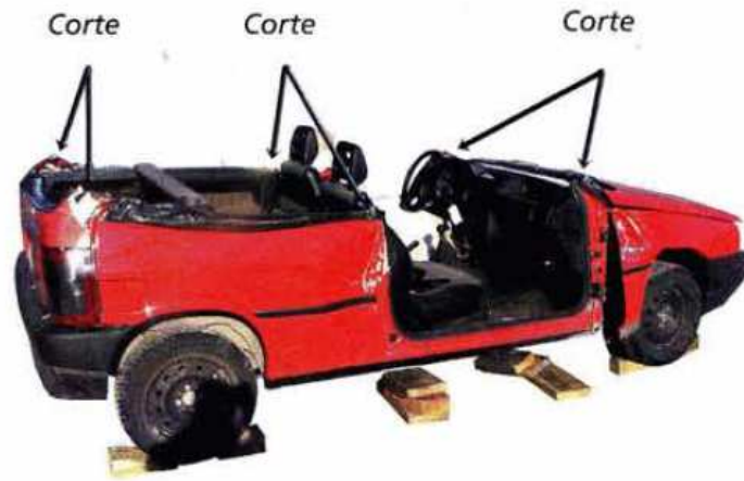
Figura AIII18. Aspecto del vehículo tras la eliminación del techo
