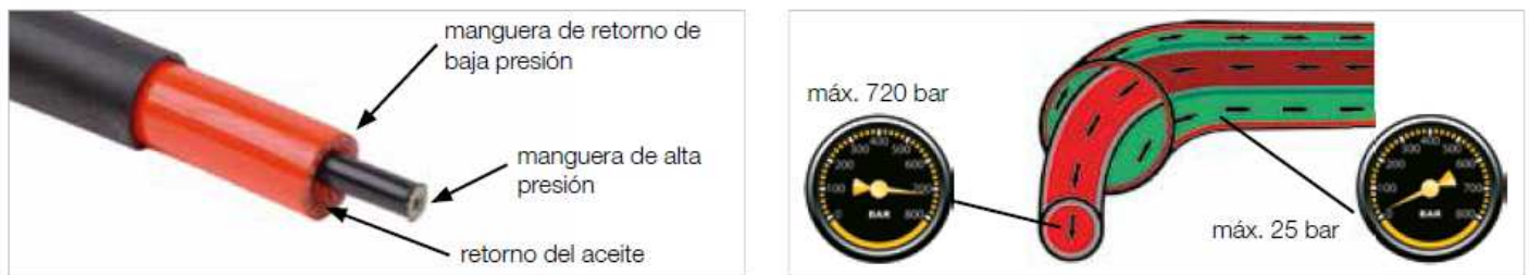
Figura AIII47. Esquema de funcionamiento del sistema CORE
