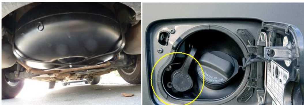
Figuras AII14 y AII15. Depósito toroidal de GLV y tapón identificativo
