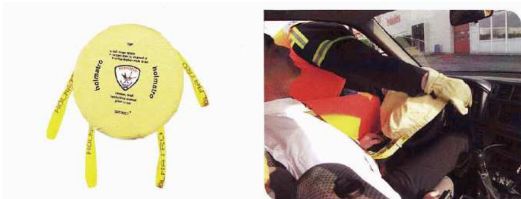
Figuras AIV58 y AIV59. Aspecto y colocación de un protector de airbag
