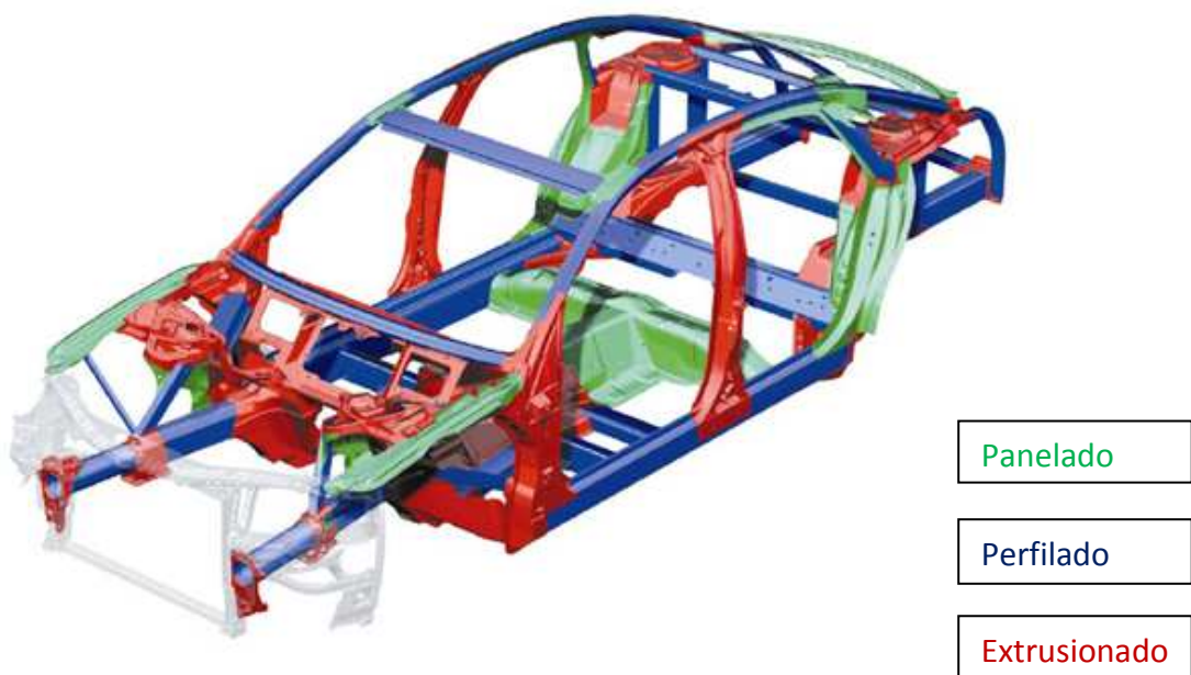
Figura AI22. Diferentes formas de fabricación del acero en elementos de un vehículo
