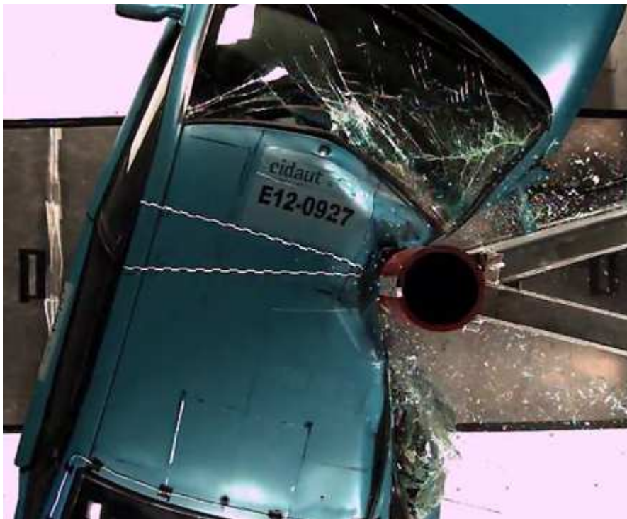
Figura A19. Deformación en caso de choque lateral
