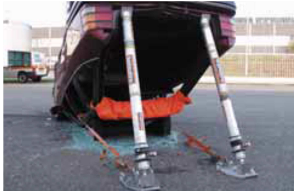
Figura AIII28. Estabilización del vehículo mediante puntales
