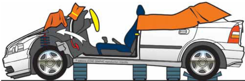
Figura AIII37. Aspecto del vehículo tras la eliminación del techo, el desplazamiento del tablero y la creación de acceso al área de los pies
