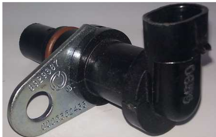
Figura AIV48. Aspecto de un sensor SRS
