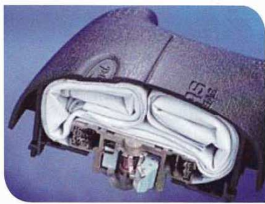
Figura AI24. Aspecto que presenta un airbag frontal, en forma de paracaídas plegado
