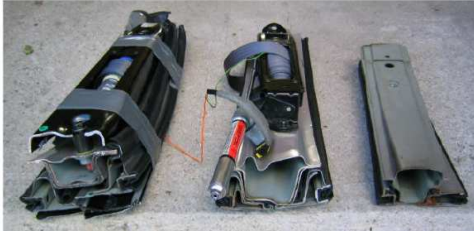
Figura AI15. Comparativa entre secciones de montantes B de diferentes modelos de Volvo
