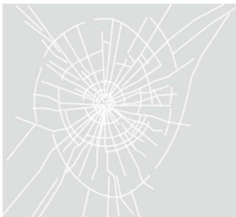
Figuras AIII15 y AIII16. Diferencia de forma de rotura de cristal laminado (izquierda) y templado (derecha)
