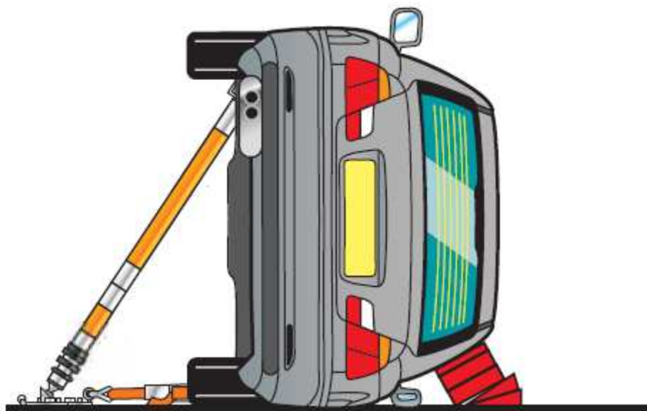
Figura AIII5. Estabilización mediante cuñas y apuntalamiento
