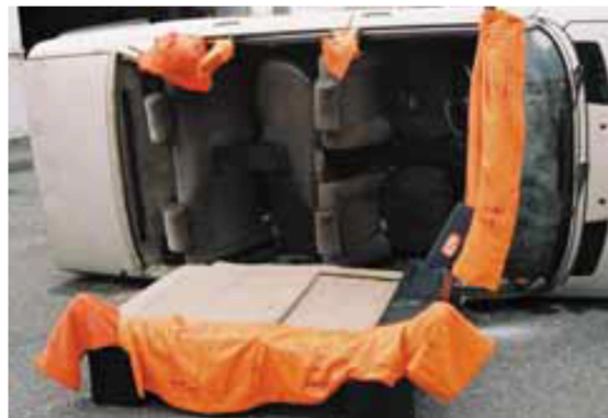
Figura AIII24. Colocación de protecciones frente a cortes
