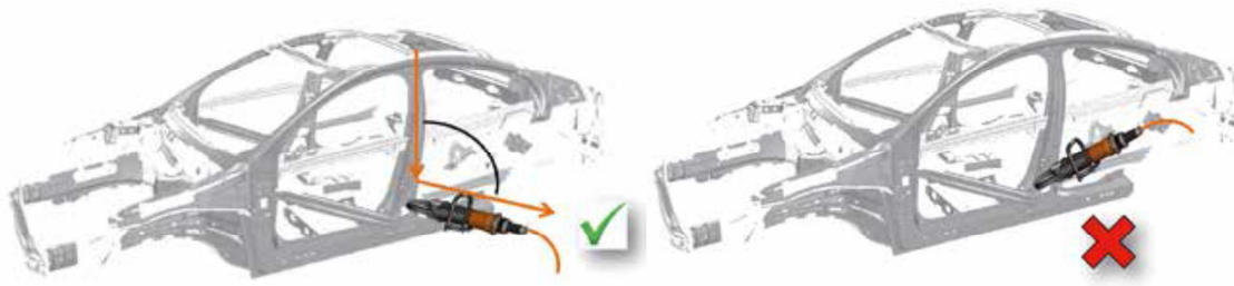
Figura AIII77. Comparativa entre posición correcta e inclinada de la herramienta
