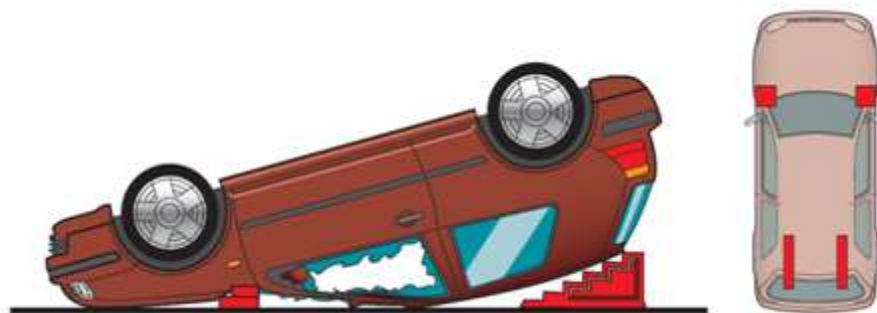
Figura AIII7. Disposición de cuñas para asegurar estabilidad
