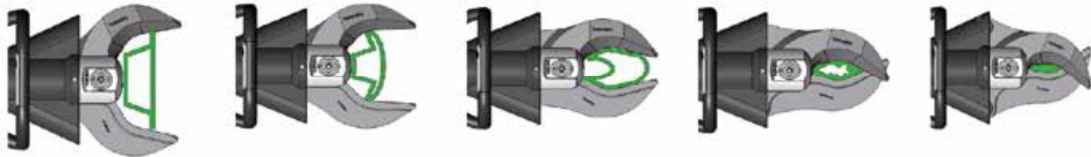
Figura AIII78. Secuencia correcta de corte de bisagra
