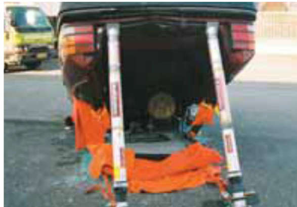
Figura AIII30. Creación de amplio espacio de trabajo para la liberación de las víctimas
