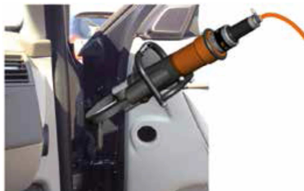
Figura AIII79. Encajonamiento de la cizalla al no haber creado el espacio suficiente
