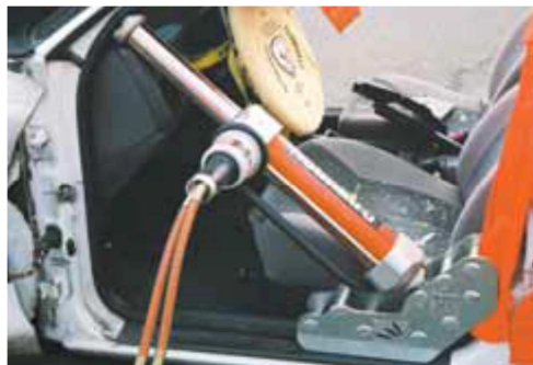
Figura AIII35. Colocación del cilindro separador
