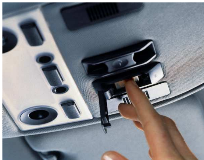
Figura AIV82. Accionamiento manual del sistema eCall
