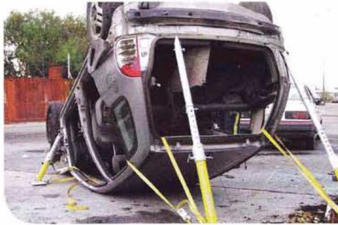
Figura AIII8. Uso de puntales en vuelco total
