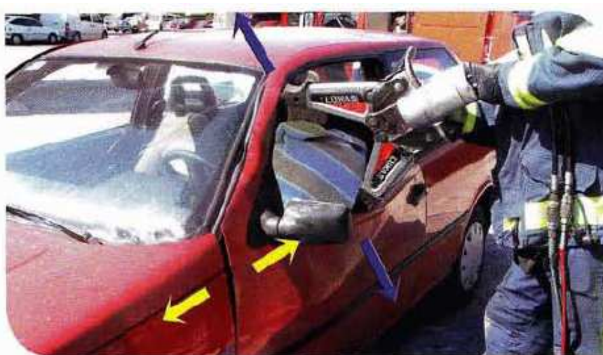
Figura AIII10. Apertura de huecos mediante aplastamiento de la puerta
