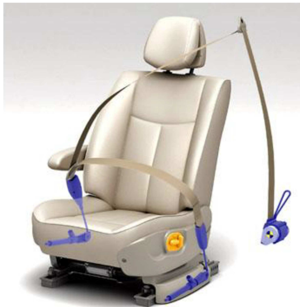
Figura AI30. Combinación de pretensores pirotécnicos tanto en hebilla como en bobinador
