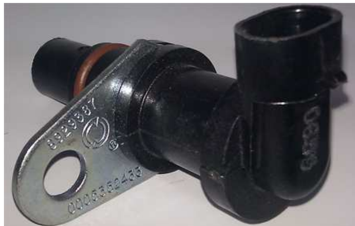
Figura AIV66. Aspecto de un sensor SRS
