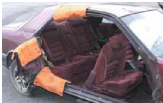
Figura AIII34. Aspecto final de la tercera puerta creada
