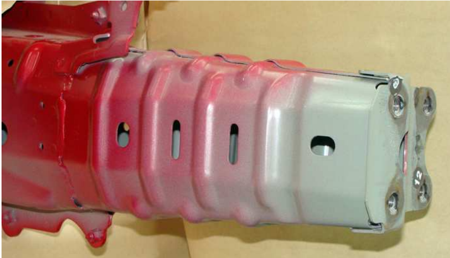
Figura A17. Larguero diseñado para la absorción de energía de impacto
