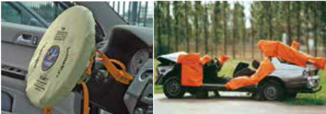
Figura AIII68 y AIII69. Protector de airbag en caso de activación repentina y cubiertas de protección de bordes cortantes de cristales y estructura
