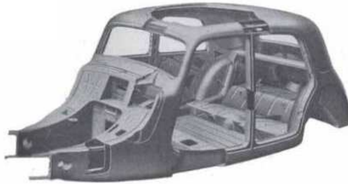
Figura AI1. Carrocería autoportante del Citroën 7cv
