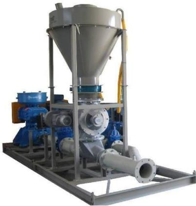
FIGURA 2 Soplane de émbolos + tolva descarga
