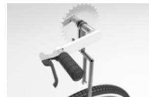
El piñón alojado en el eje con una chaveta transmite el movimiento al neumático, este va protegido por el embellecedor, la imagen del medio muestra la horquilla y el tubo telescópico que van **roscados** para que el sistema de pedaleo gire a la vez que el asiento y además permita la colocación del sistema a gusto del usuario y permita la retirada de este para el **traspaso** del usuario.
