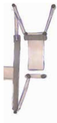
Sin embargo al tener la pieza que sale del asiento y permite el sistema de cambio y un asiento compuesto por tres piezas, se tubo que poner una **sistema de varillas** que en vez de girar sobre un eje girase sobre dos, para dejar una zona de distancia constante.
