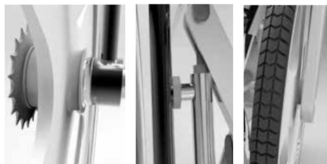
En la imagen inferior se puede ver como el embellecedor protege al piñón y al sistema en general, además de ver como va colocada cada pieza siendo el embellecedor, la horquilla y el tubo telescópico los que giran independientemente del giro de la rueda.
