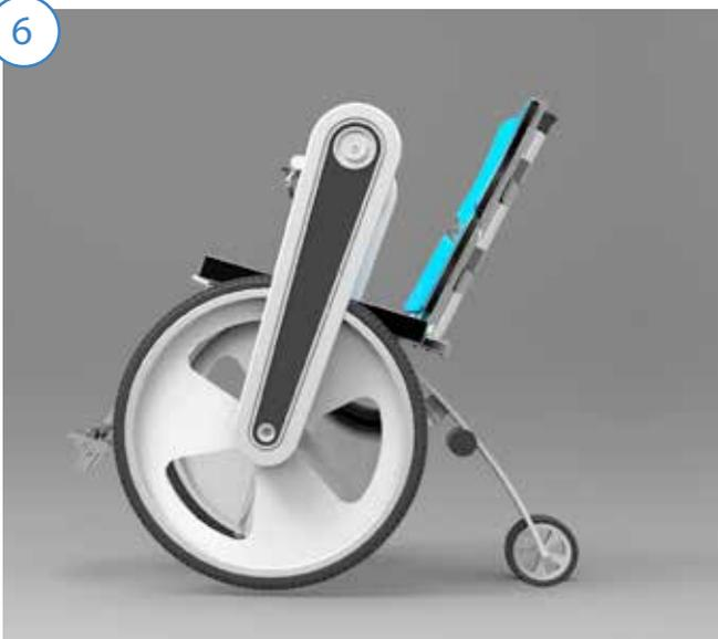
Para volver al sistema de silla de ruedas, se realizaría de la misma forma, sólo que girando la palanca en el sentido contrario, de esta forma volveríamos a la posición inicial de silla de ruedas.
