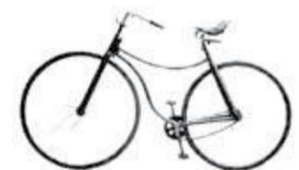
Donde la rueda delantera es mas pequeña gracias al uso de los rodamientos, es propulsada por una cadena, se le acoplo frenos para una mayor seguridad. Añadiéndose poco después, 1888, los neumáticos por John Boyd Dunlop, donde en su tubo interior se rellenan de aire, amortiguando parte del golpeo contra los caminos.
