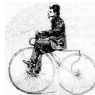
Se acoplaron bielas y pedales a la rueda delantera. Siendo la rueda delantera de mayor diámetro que la trasera.
