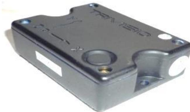
Para las pruebas de evaluación de la capacidad funcional lumbar y dorsal se utilizan un total de 7 sensores inerciales inalámbricos de la marca Colibrí. Estos sensores irán sujetos al cuerpo de la persona a evaluar, mediante un conjunto de fijaciones como posteriormente se indicará
