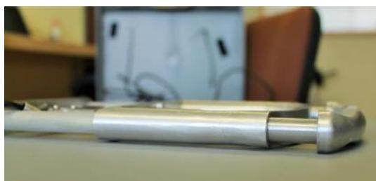
Para las pruebas de dinamometría de manos, es necesario esta estructura para transmitir la fuerza humana ejercida por el sujeto al sensor (Célula de carga).
