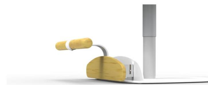
El utilaje de dinamometría consta de 4 partes: Las células, la placa donde se realiza la fuerza de compresión, el cilindro donde se realiza la fuerza de flexión, y la pletina que une ambos. Siguiendo formas curvas del resto del asiento
