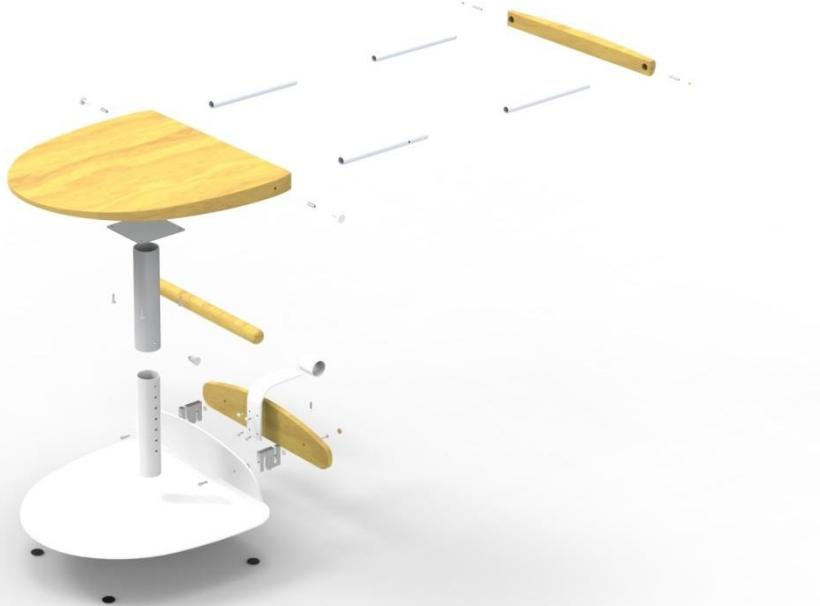
*Fig 12. Explosión de los componentes Silla Multifuncional.*
