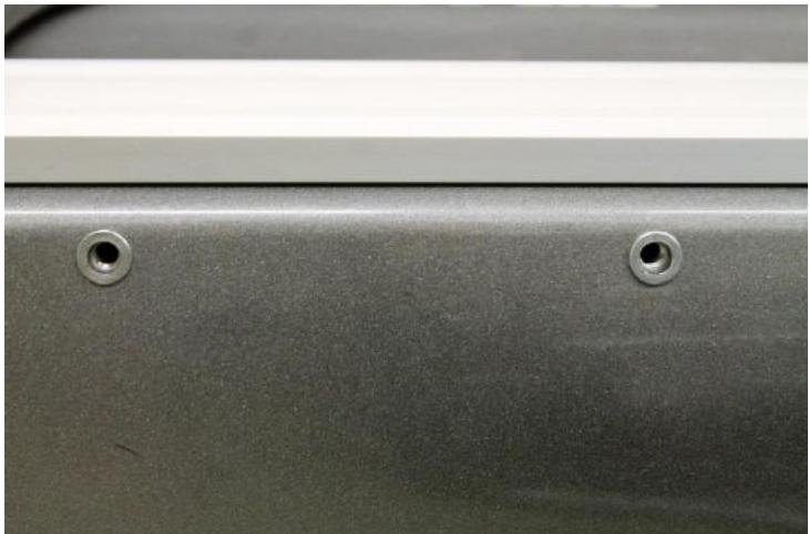
En estos orificios se atornillan dos tubos de las mismas características (Diámetro 30mm y aluminio anodizado) y una longitud de 50mm, que soportan otro dispuesto horizontalmente con una longitud de 300mm. Para que los dos tubos se adapten se mecanizó en el taller de la Universidad, un casquillo de circunferencia de 15mm.
