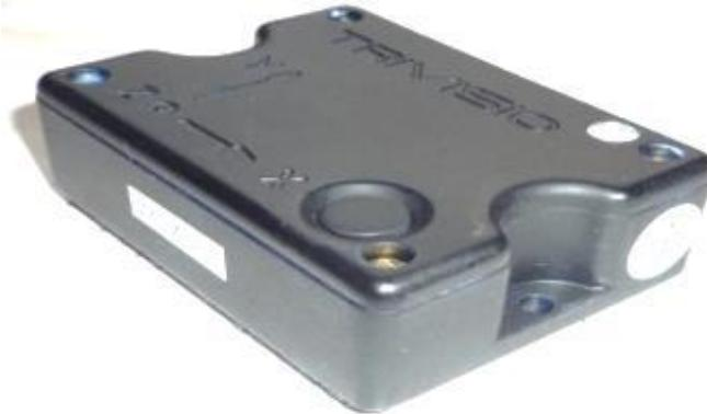
Para las pruebas de evaluación de la capacidad funcional cervical y de hombros se utilizan un total de 9 sensores inerciales inalámbricos de la marca Colibrí. Estos sensores irán sujetos al cuerpo de la persona a evaluar, mediante un conjunto de fijaciones como posteriormente se indicará.
