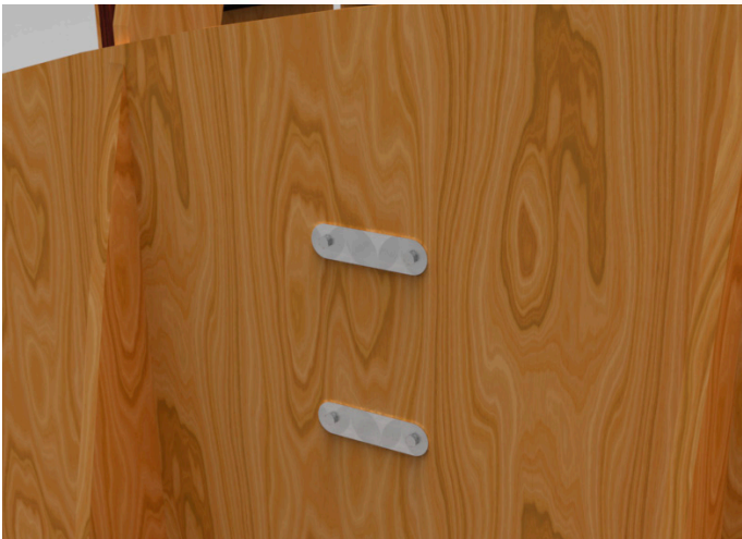
Fig. 155- Secciones unidas con chapas y pasadores.
