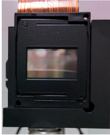
Figura 3.2: Foto del SLM utilizado para el montaje experimental
