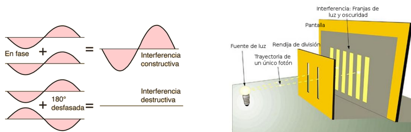
(a) Arriba: interferencia constructiva, resultado de superponer dos ondas en fase. Debajo: interferencia destructiva, resultado de superponer dos ondas desfasadas 180 grados
