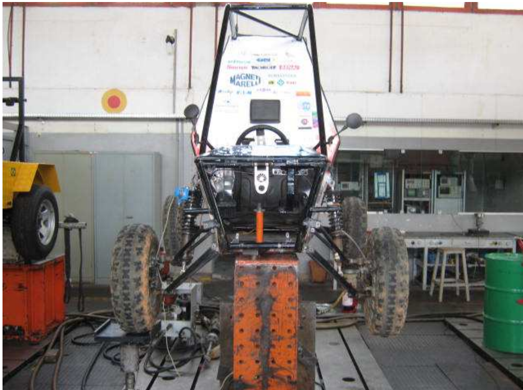
Figura 3-1: Test de razón de instalación y fuerzas del sistema amortiguador/muelle
