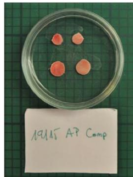
Figura 1. 2 Probetas para el ensayo de compresión.
