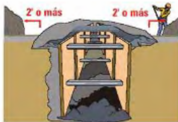
Figura 1. Apuntalado de zanjas y distancia mínima de vertido de tierras
