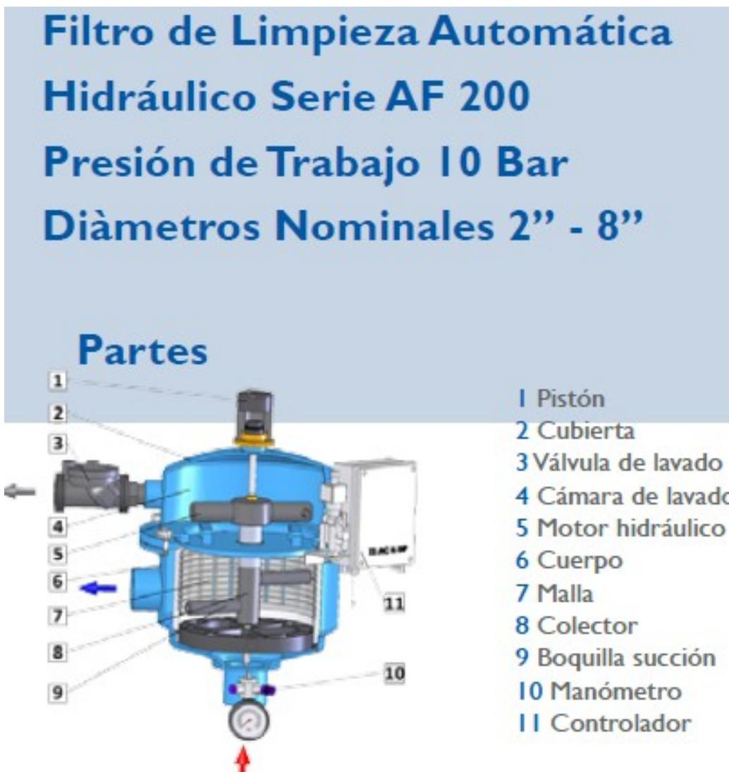
Este proceso de limpieza se produce por medio de unos inyectores con un cepillo en su punta que realiza un barrido por toda la superficie de la malla, expulsando esta agua sucia a un desagüe.
