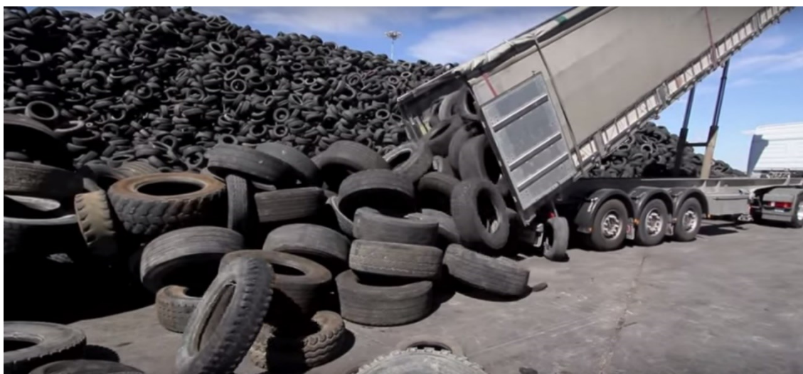
Figura III-3. Recepción y descarga de los neumáticos en la planta de reciclaje
