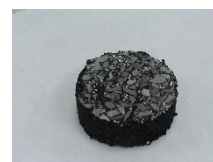
Figura IV-3. Aditivo de caucho al betún asfáltico
