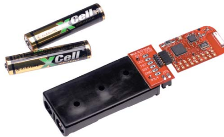
Figura 5: Adaptador de pilas para alimentar el dispositivo End Device
