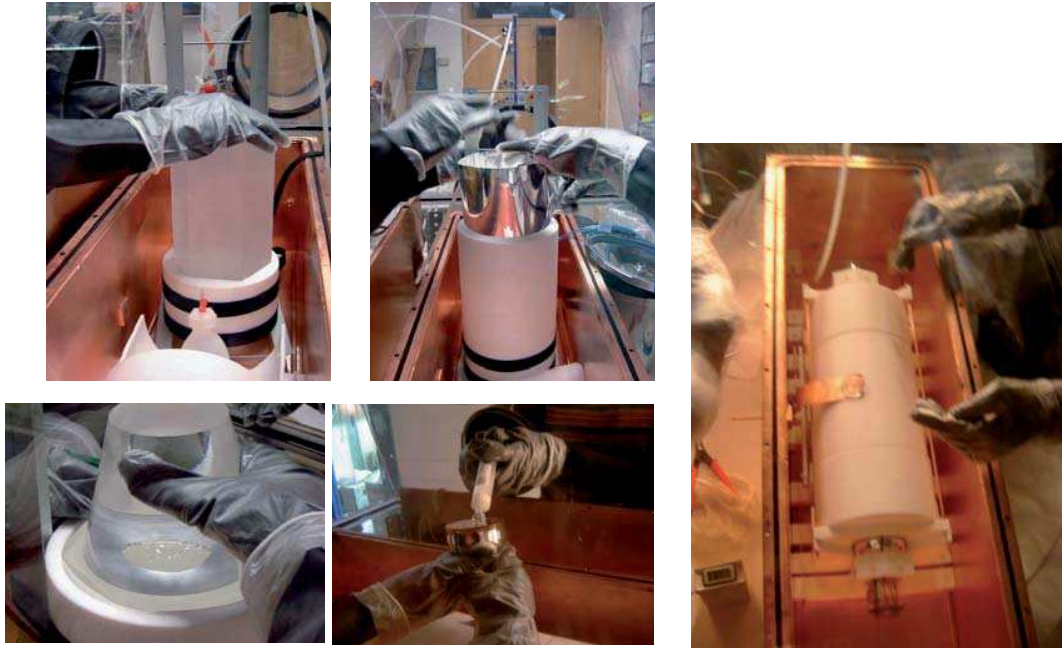
Figura 21: Proceso de montaje de uno de los cristales de 10,7 kg de NaI como Prototipo II en los laboratorios de la Universidad de Zaragoza para su posterior instalación en el LSC. Cualquier operación que implique el contacto del cristal con la atmósfera debe ser evitada y por eso se ha trabajado en una caja de guantes especialmente diseñada para ANAIS. (En color en la versión digital)
