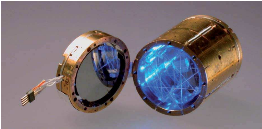
Figura 23: Bolómetro doble de BGO utilizado durante la última serie de medidas del experimento ROSEBUD en Canfranc. (En color en la versión digital)
