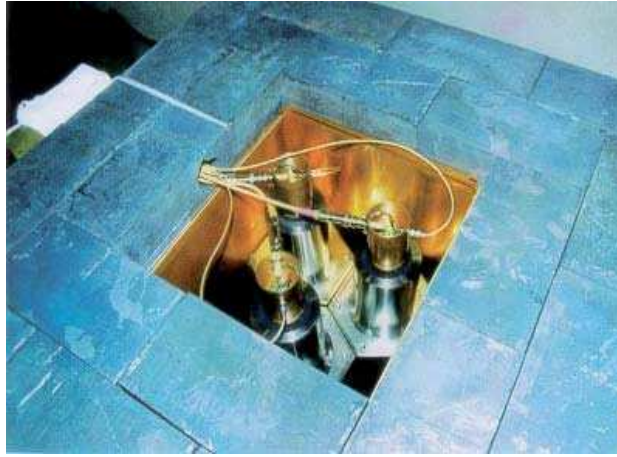
Figura 20: Blindaje del experimento DM32: tres detectores de NaI(Tl) en el Laboratorio 1 del LSC con el objetivo de estudiar la modulación anual en los ritmos de interacción. (En color en la versión digital)
