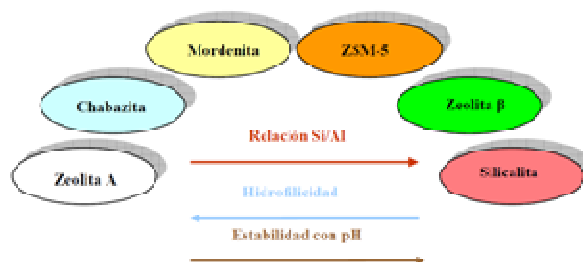
Figura II: Tipos de zeolitas según su relación Si/Al
