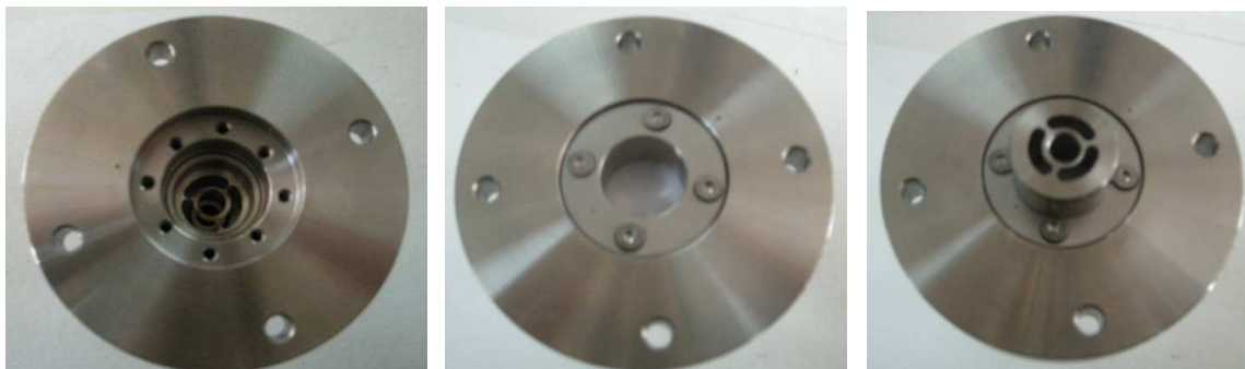
Figura XXVIII: Pasos para la colocación de la membrana
