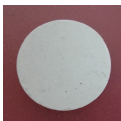
Figura XX: Muestra de una pastilla de 13 mm de diámetro y 1 mm de espesor de zeolita
