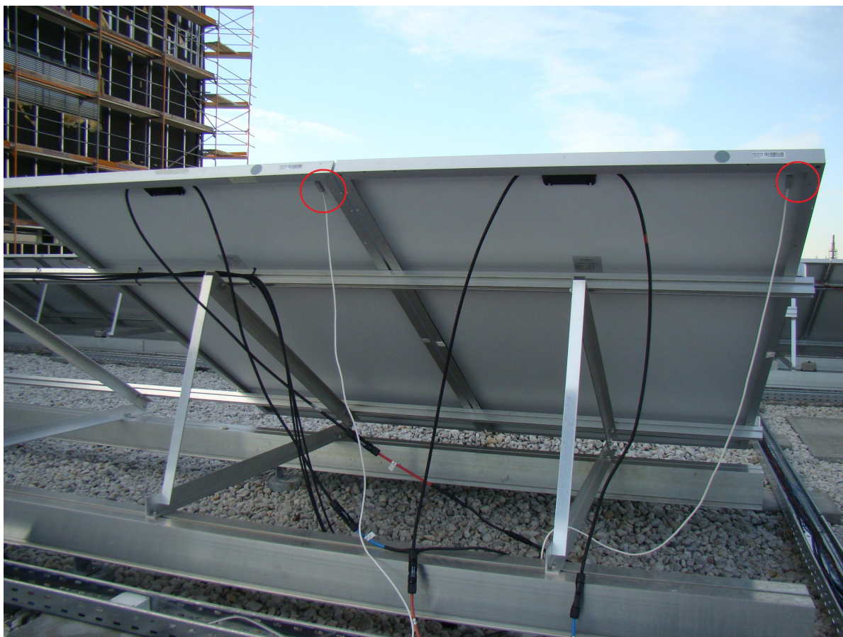
Figura 4.2.: Termómetros de temperatura del módulo adheridos al Tedlar
