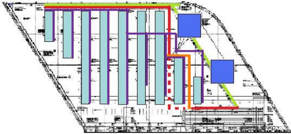
Figura 2.6.: En verde el primer trazado del camino en la azotea, en rojo continuo y discontinuo el trazado del segundo mapa, la parte discontinua no existe, siendo el camino real el naranja en ese tramo. En morado, las bandejas de cableado actuales.
