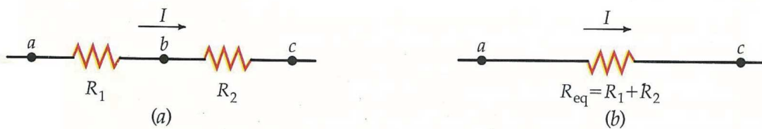
Figura 20: (a) Dos resistencias en serie; (b) Las dos resistencias pueden sustituirse por una equivalente.
