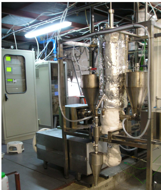
Figura 2.9. Planta piloto de lecho fluizado de 2.5 kW th
