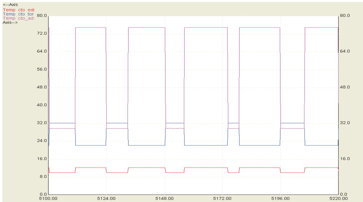
Figura 27. Simulación de TRNSYS que representa las temperaturas de entrada y salida de los 3 circuitos de la máquina de adsorción, siendo el rojo el del edificio, el morado el propio de la máquina de adsorción y el azul, el de la torre de refrigeración.
