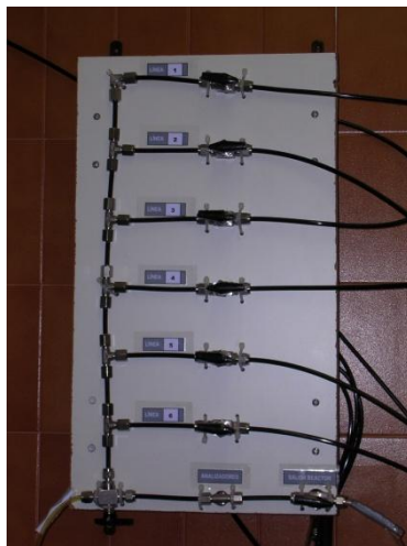
Figura III.8. Panel de válvulas de bola de tres vías.
