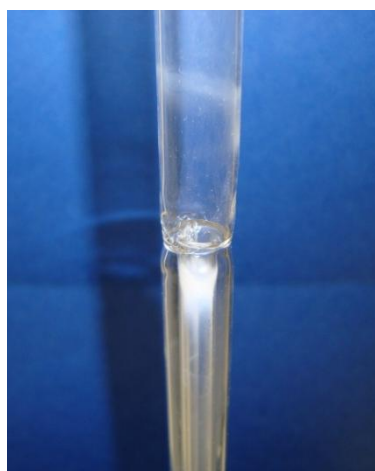
Figura III.10. Foto del estrechamiento del reactor para el estudio de la interacción hollín-NO.
