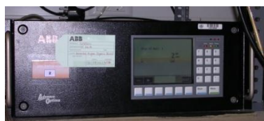
Figura III.16. Analizador de NO (ABB ADVANCE OPTIMA con módulo analizador Uras 14).
