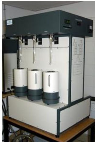
Figura V.13. Equipo volumétrico automático de adsorción física de gases AUTOSORB-6 y degasificador AUTOSORB DEGASSER (Quantachrome).
