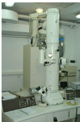
Figura V.1. Microscopio electrónico de transmisión.
