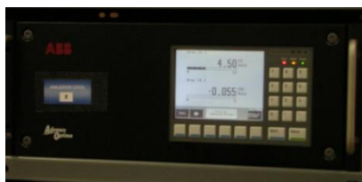
Figura III.15. Analizador de CO/CO 2 (ABB ADVANCE OPTIMA con módulo analizador Uras 14).
