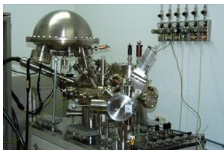
Figura V.10. Equipamiento del análisis por espectroscopia de rayos X.
