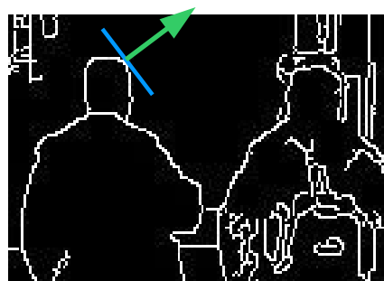
Figura 12. Detección de borde sobre la imagen de entrada Figura 13. Vector gradiente en uno de los puntos de borde
