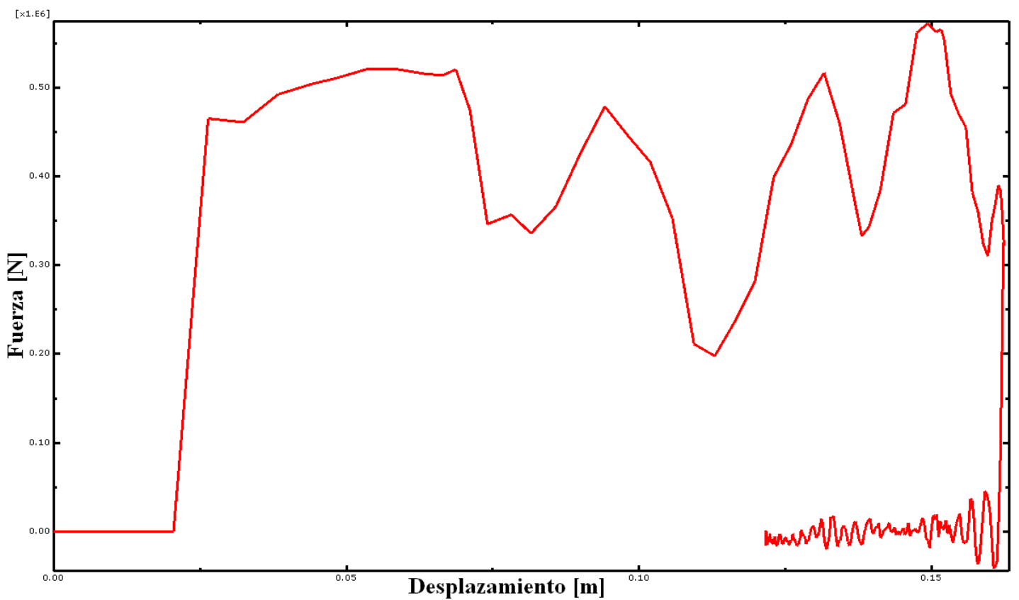
Gráfica 4.10.2. Tensión-Deformación – Geometría 5 – Duraluminio
