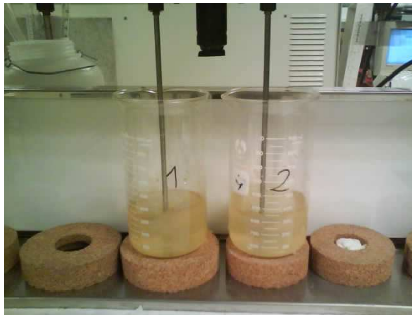
Figura 6.9. Etapa de coagulación del FeCl 3
