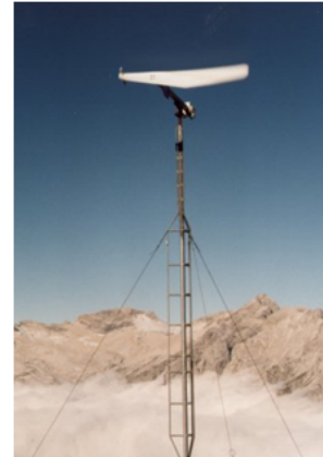
Imagen 8.3.7: Aerogenerador monopala. Fuente: windpower.
