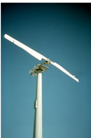
Imagen 8.3.8: Aerogenerador bipala. Fuente: Windpower.
