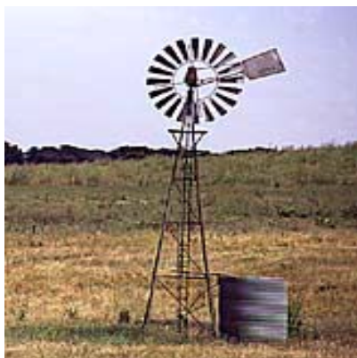
Imagen 8.3.15: Instalación eólica aislada de bombeo de agua.
