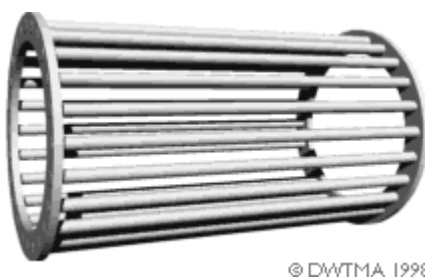
Imagen 8.3.14: Rotor de jaula de ardilla o bobinado. Fuente: windpower.
