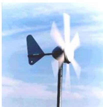
Imagen 8.3.9: Aerogenerador multipala. Fuente: windpower.
