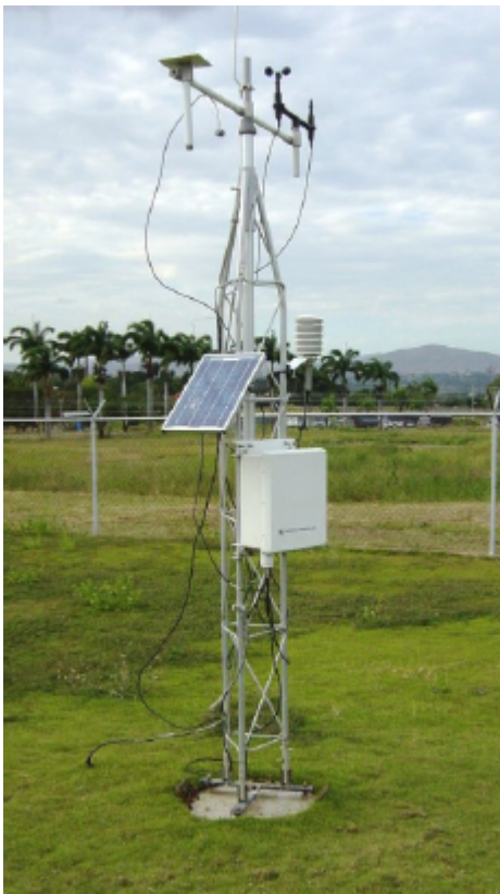
Imagen 2.1.2: Estación meteorológica automática.
