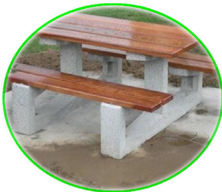
El diseño de esta mesa combina materiales de los distintos vistos en los dos productos anteriores. Los soportes estructurales son de prefabricadas de piedra de granito artificial y los listones tanto de los asientos como de los bancos son de madera de Elondo barnizados con brillo al agua. El conjunto se empotra al pavimento mediante cemento cola. Los tableros de Elondo están ensamblado al granito mediante taco-varilla roscada-tuerca.
