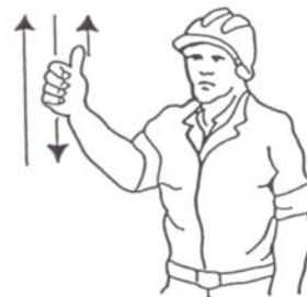
4 Levantar el aguilón o pluma lentamente
