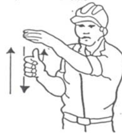
4 Levantar el aguilón o pluma lentamente
