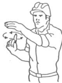
3 Levantar la carga lentamente
