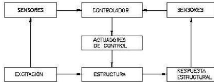
Esquema de funcionamiento de un sistema de control activo
