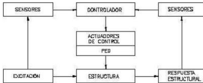
Esquema de funcionamiento de un sistema de control semiactivo
