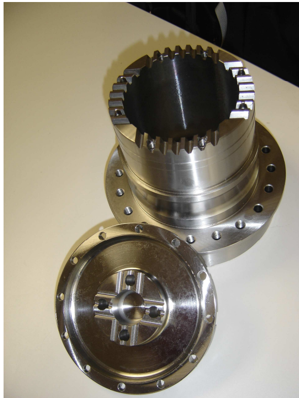
Fig.8 Mecanizado de elementos de frenado para tren
