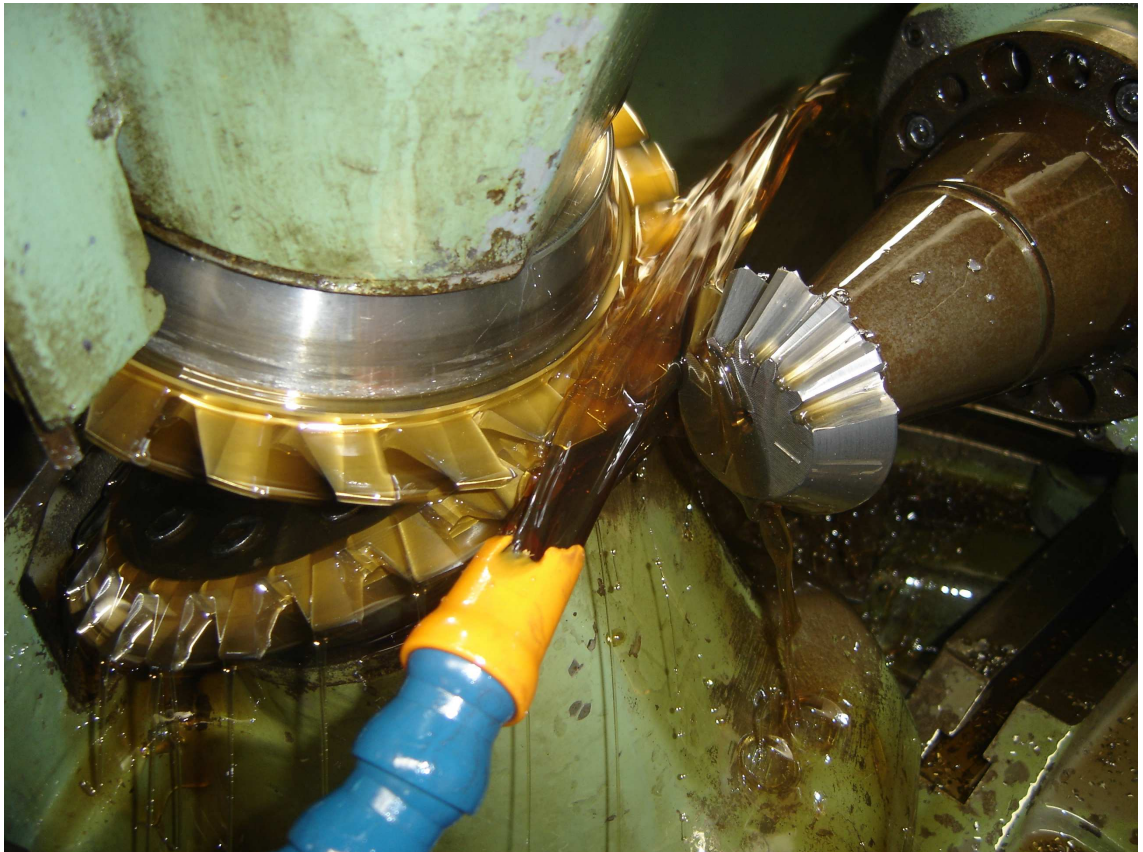
Fig.6 Tallado de piñón cónico recto en talladora Gleason
