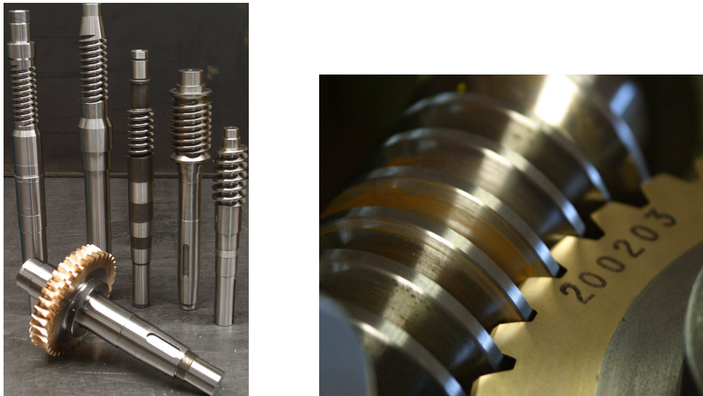
Fig.2 Mecanismo de transmisión Sinfín-Corona
