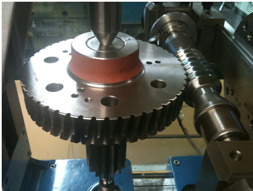
Fig.3 Verificación a rodadura del mecanismo
