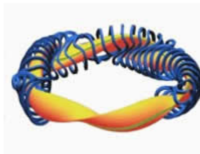
Plasma (amarillo) en la bobina magnética (azul)
