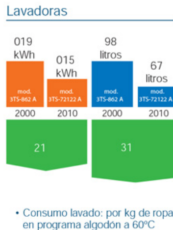
Figura 4.6. Consumo de energía y agua de lavadoras Balay. Fuente: Electrodomésticos Balay
