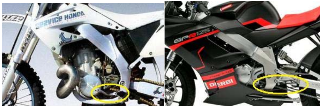
Imagen 6.2. Se observa la diferencia entre la distancia del eje de cambio del motor y la estribera. En la de la derecha está muy cerca (cross) y en la otra la estribera está mucho más retrasada (carretera).
