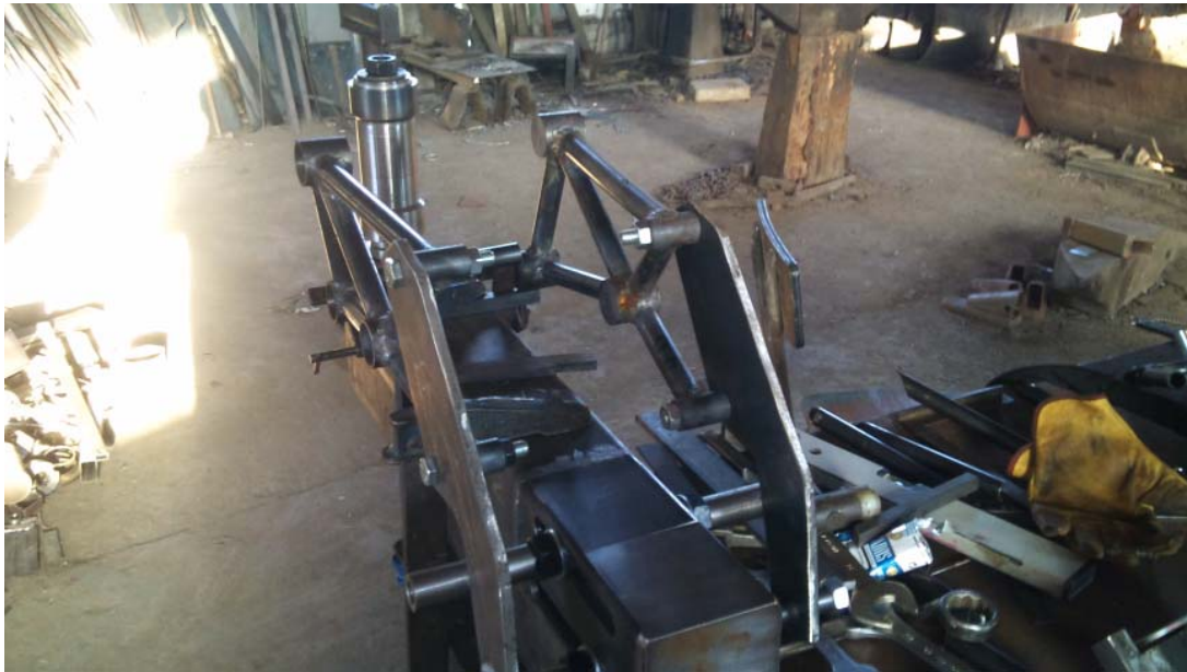
Imagen 7.11. En esta foto se ve como aún queda por soldar la parte de la suspensión trasera y la pipa.
