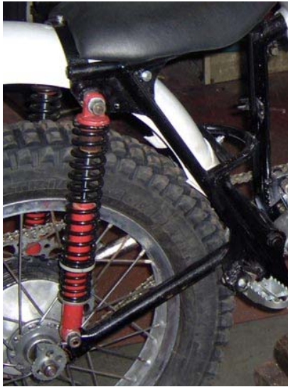
Conexión al final del basculante. Se observa la simplicidad del montaje. La imagen pertenece a una Bultaco del año 1960.
