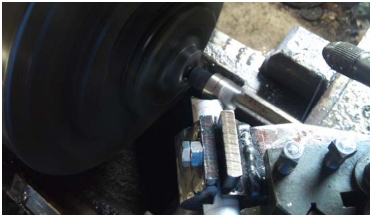
Imagen 7.6 Se observa como la mesa del torno se va acercando a la corona que está en el plato de garras.
