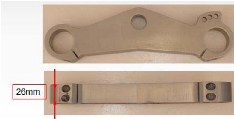
Imagen 3.12. Tijá inferior y medida de la anchura.
