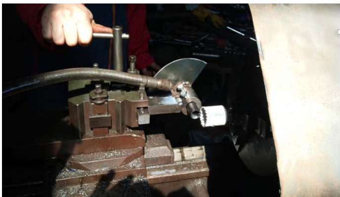
Imagen 7.5 Se coloca el portaherramientas con el Angulo indicado con respecto husillo. Con el utillaje también se controla la longitud y el ángulo de una pasada con respecto a otra.
