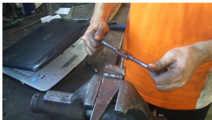
Imagen 7.3. Utillaje para cortar los tubos en el torno, se están haciendo las roscas ya que el tubo va a presión mediante dos tornillos, que en la punta están redondeados para no dejar marca en el tubo.
