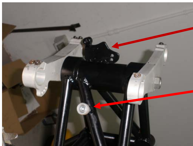
Imagen 7.15. No debemos olvidarnos de soldar la sujeción del carenado y los topes de dirección.
