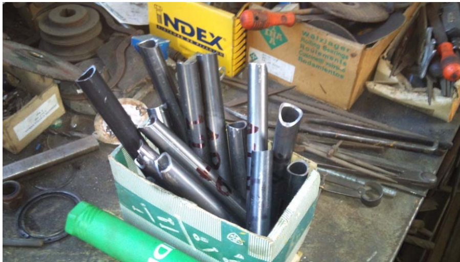
Imagen 7.2. Tubos ya cortados y preparados para soldar.
