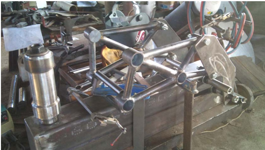
Imagen 7.10. En la foto se observa la pipa a la izquierda de la foto, antes de ser soldada al resto del chasis. Ya están colocados los dos lados del chasis, soldados aparte.
