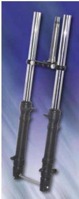
Imagen 3.10. La suspensión proporcionada por la organización. La monta la Yamaha TZR 50.
