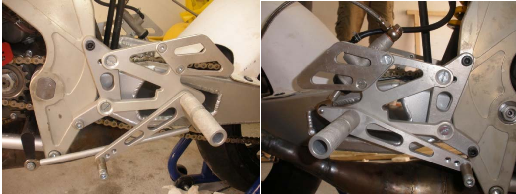
Imagen 6.3. En las fotos se observa el resultado final completo de las estriberas. A la derecha el lado del cambio y a la izquierda el del freno.
