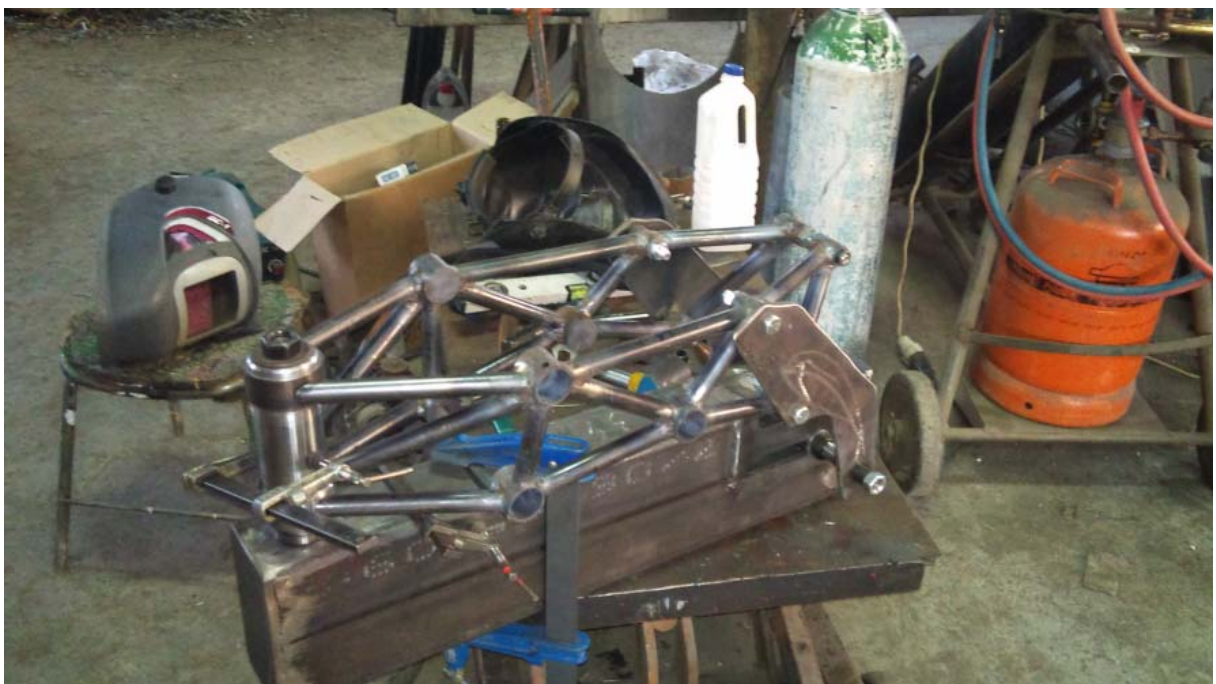
Imagen 7.12. En la última foto una vez soldada la pipa y la parte de la suspensión trasera.
