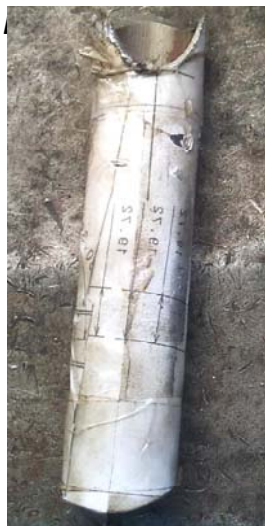
Imagen 7.7 Uno de los tubos con mayor cantidad de pasadas y cogidas.
