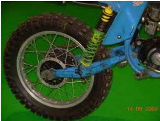
Conexión en ángulo. La posición de anclaje en el basculante está más adelantada y forma ángulo con la unión al chasis.
