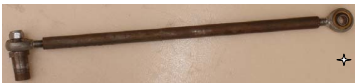
Figura 5.29. Montaje con semieje de unión al basculante
