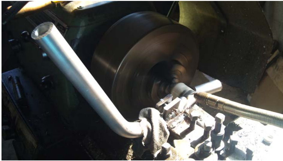
Imagen 7.17. Un tubo ya doblado cortándose en el utillaje especial para el torno
