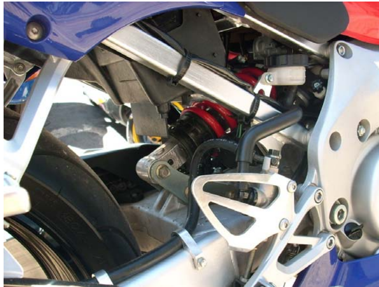
Figura 5.13. Sistema de balancín en el basculante en una moto Honda CBR600
