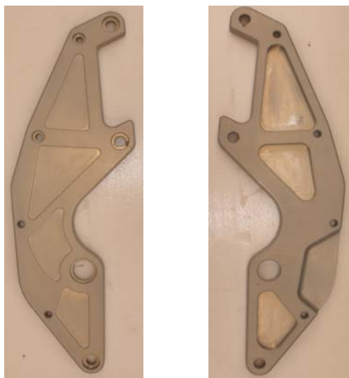
Imagen 2.15. Placa de aluminio derecha. Se puede ver a la izquierda la cara a la vista y a su derecha la cara interior.
