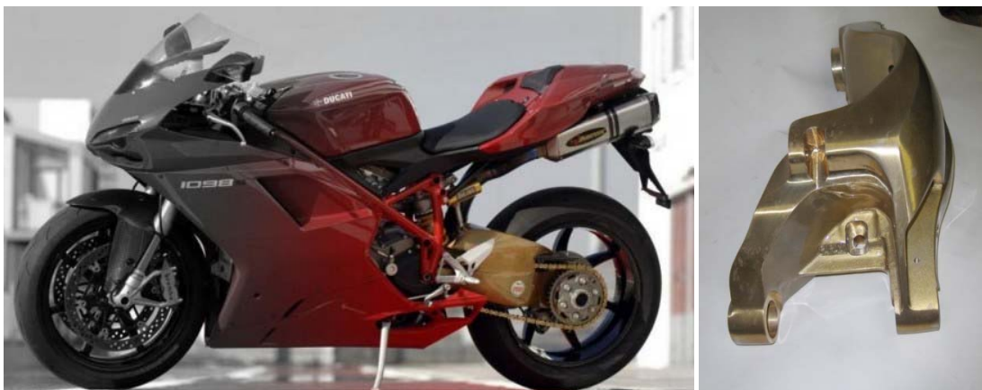
Imagen 4.1. En esta foto se muestra la Ducati 1098 que monta un basculante monobrazo.
