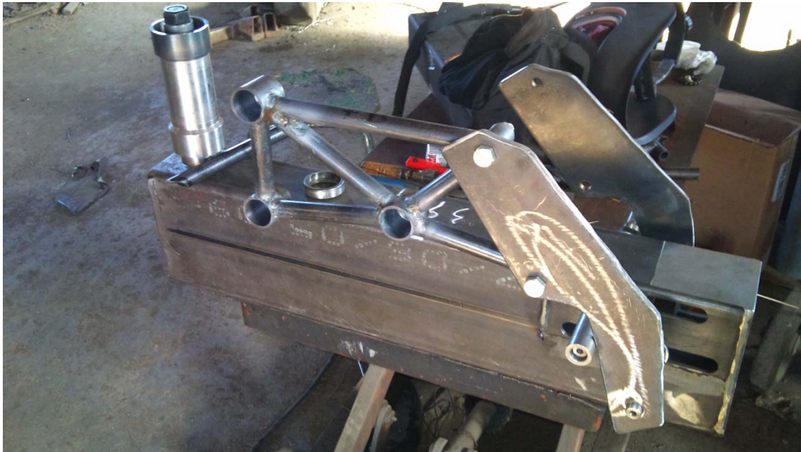
Imagen 7.9 Se observa bastante bien como el potro mantiene al chasis en la posición adecuada. La parte ya soldada en esta foto se realiza aparte en una mesa especializada.
