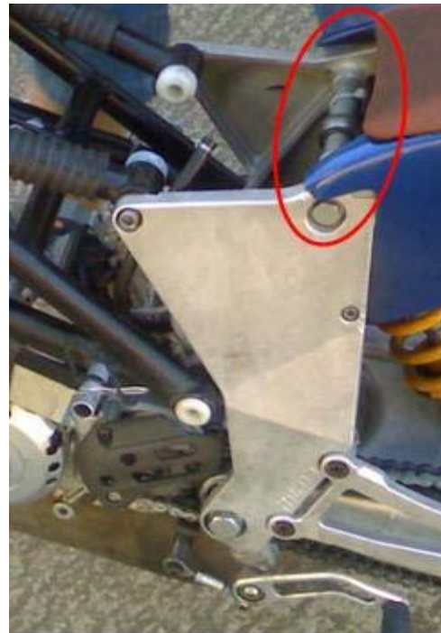
Imagen 2.13. Chasis Metrakit. En este caso se sujeta la suspensión mediante un eje. Problemas de flexión en el eje al poco tiempo de uso.
