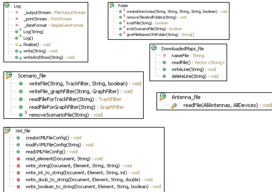
Figura D.5 – Clases del módulo File
