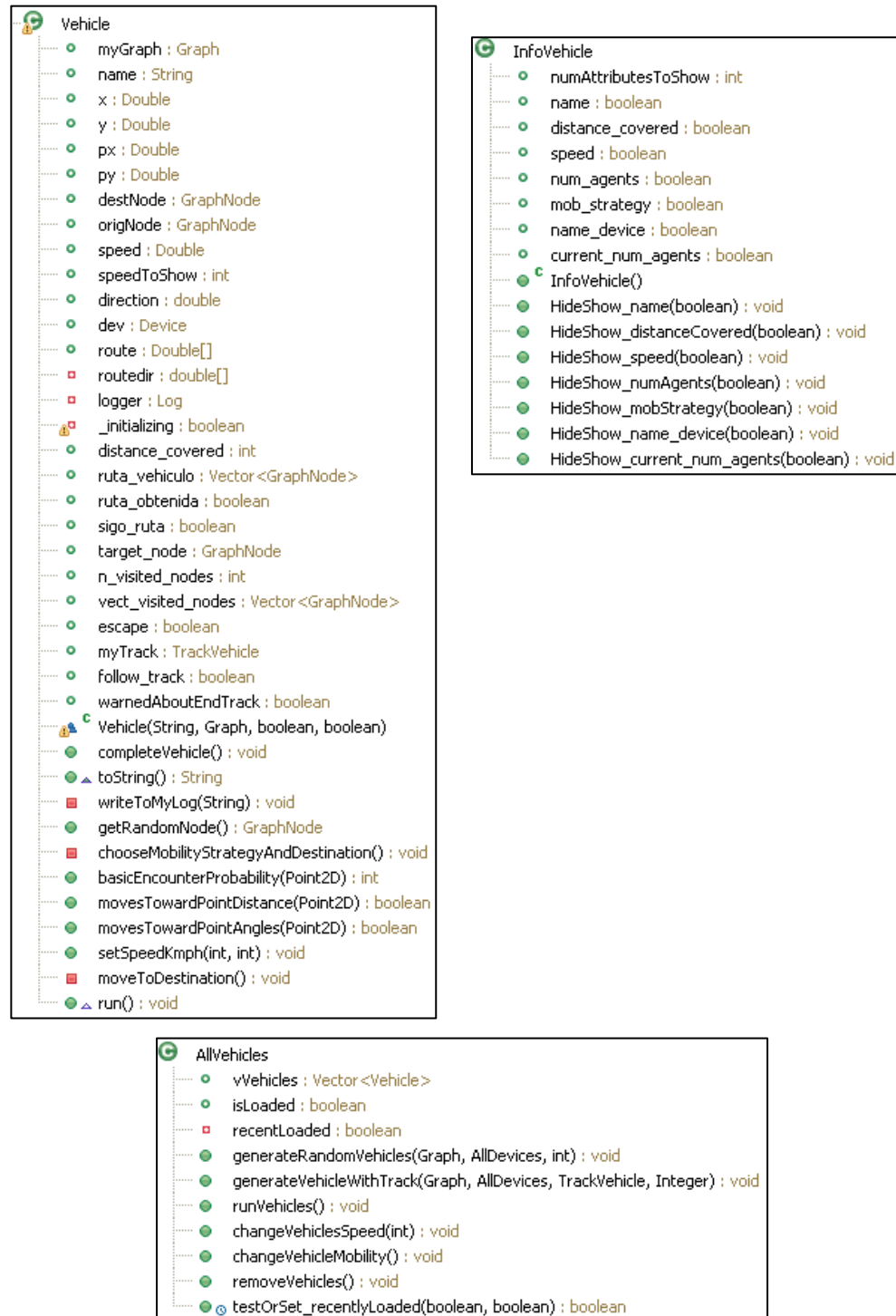
Figura D.11 – Clases del módulo Vehicle
