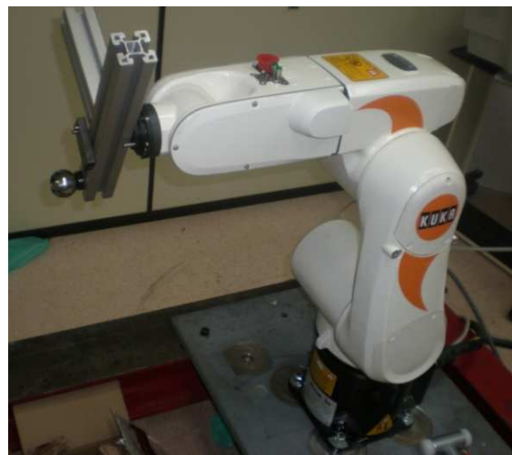
Ilustración 1 - Dimensiones y detalle de robot Kuka KR 5 sixx
