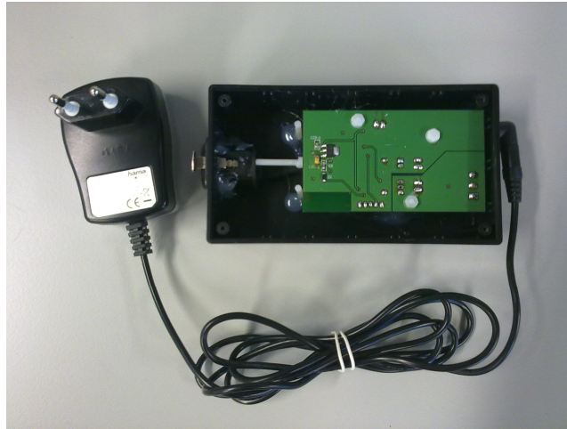
Fig. E.6.- Imagen del montaje final de la PCB instalada en la caja protectora
