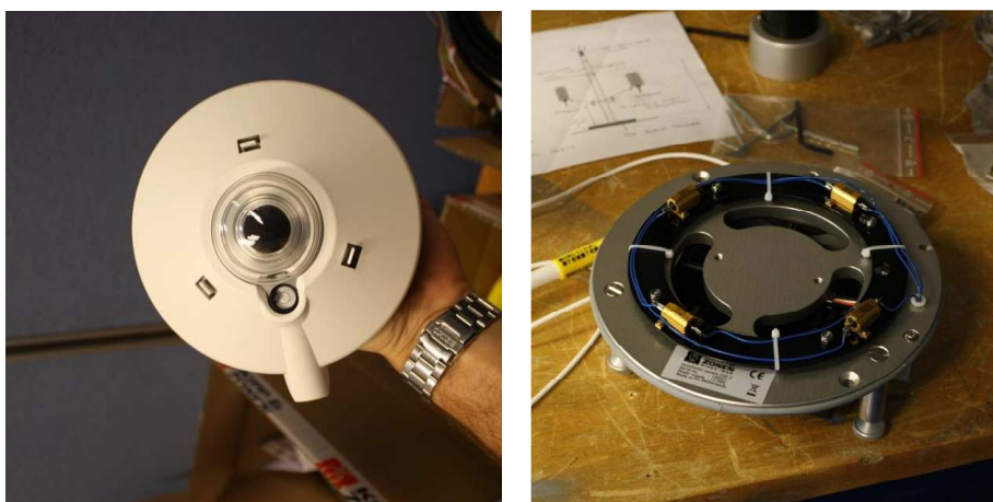
Figura 3.5. Piranómetro Kipp&Zonen's CMP22 montado bajo la cubierta de la unidad CV3. Base de la unidad de ventilación CV3 durante el proceso de montaje.
