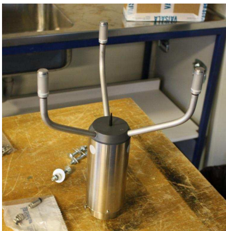
Figura 3.4. Sensor ultrasónico WS425 durante el proceso de montaje.
