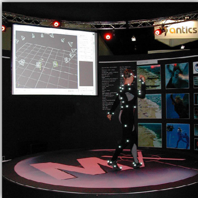
Imagen 2.25 Traje especial de esferas reflectantes para la captura de movimiento por sistema óptico. Arriba de la imagen se observan las cámaras infrarrojas emitiendo luz.
