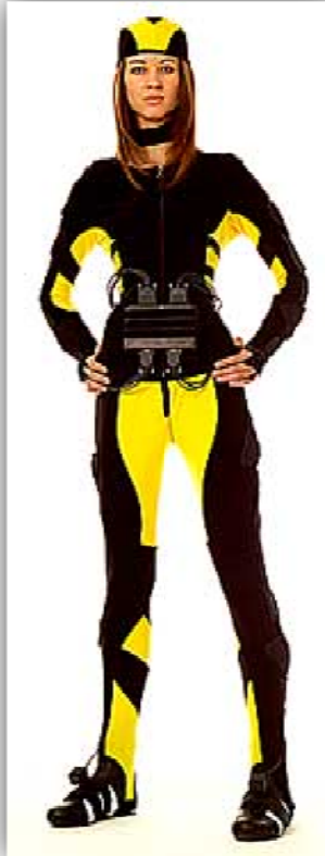
Imagen 2.24 Ejemplo traje magnético en el cual se observa la base fija de recepción de datos adherida a la cintura del traje.
