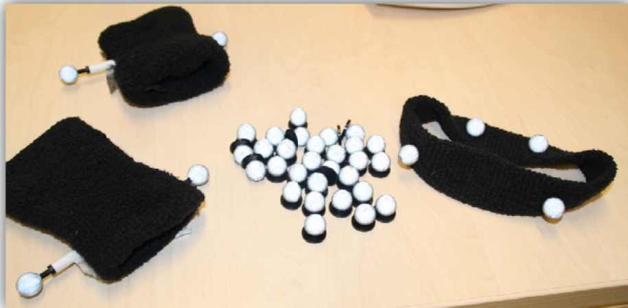
Imagen 3.6 Esferas de material reflectante. Accesorios para las muñecas (izquierda), y para la cabeza (derecha).
