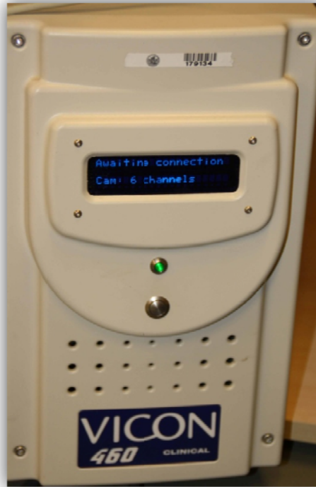
Imagen 3.5 Procesador "Datastation" del sistema Vicon 460. En el display se observa la sincronización de las 6 cámaras del laboratorio del I3A.
