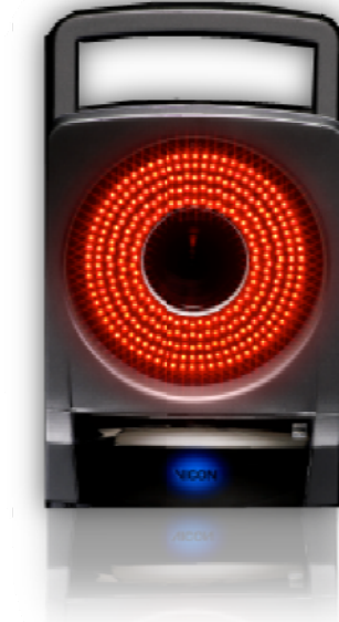
Imagen 3.3 Cámara de la compañía Vicon. Se observa la luz infrarroja de los led's.
