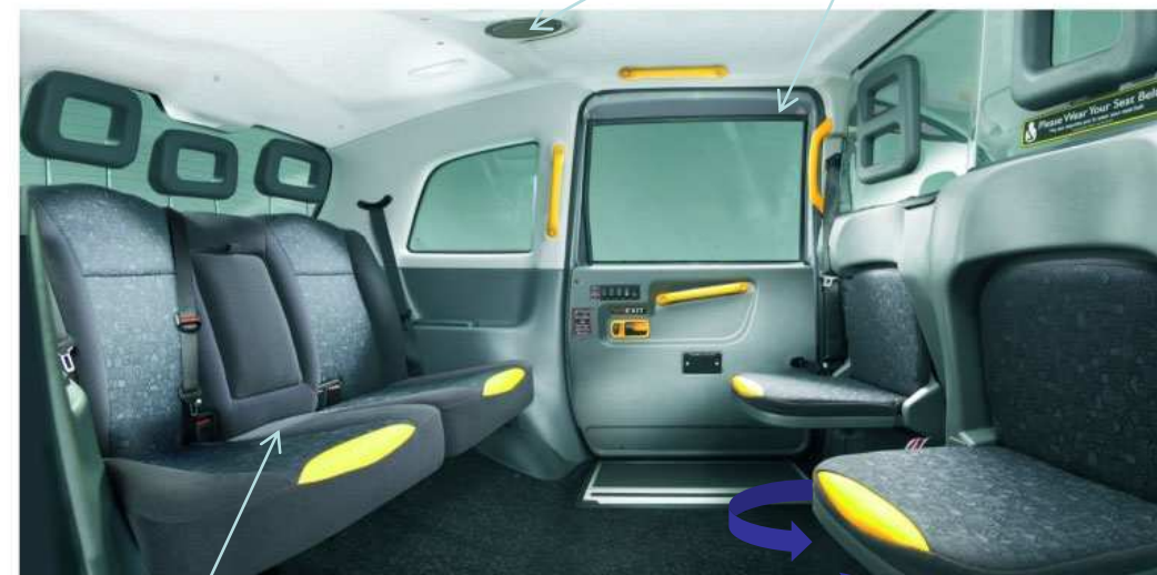
Altavoz y micrófono para la comunicación usuario – conductor.
