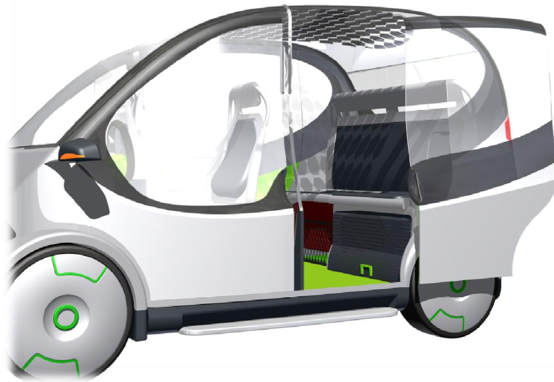
En la imagen podemos observar como queda cargada toda la parte bajo los asientos con maletas. Bajo las plazas de la derecha la carga queda retenida por el sistema de lamas mientras que en la zona derecha queda retenida por la malla extensible.
