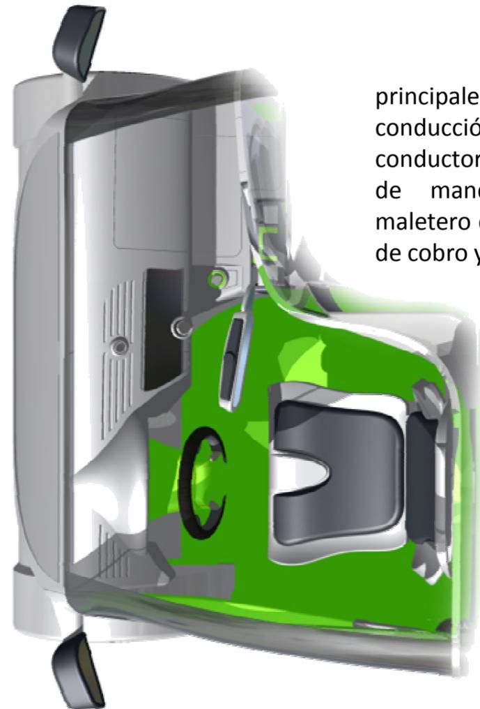
Los elementos principales del puesto de conducción son el asiento del conductor, el salpicadero con panel de mandos y retrovisores, el maletero del conductor, la máquina de cobro y maletín.
