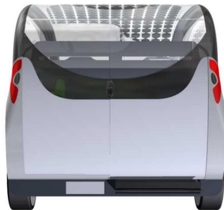
En la parte trasera del vehículo nos encontramos las puertas de acceso al maletero se trata de dos puertas verticales que funcionan similar a cualquier furgoneta, de apertura convencional, mediante giro horizontal a través de una bisagra en cada puerta.
