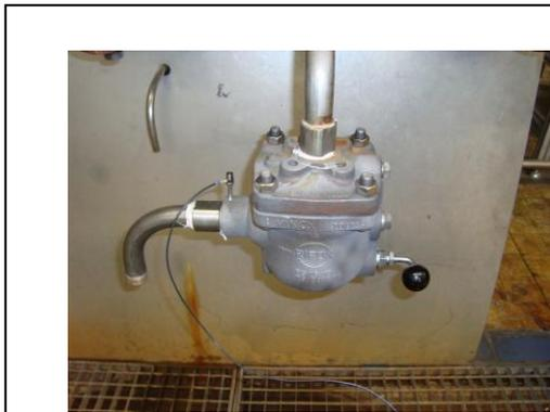
**Figura 7 Trampa de vapor con acelerómetro.**
