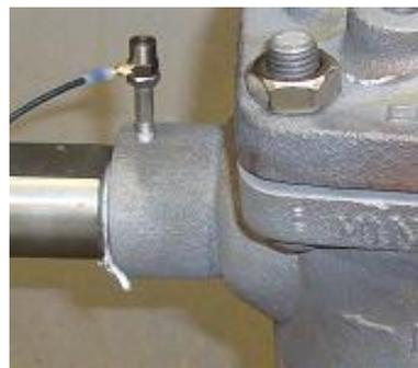
**Figura 8 Colocación del acelerómetro.**
