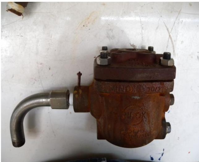
Figura 2. Trampa de vapor RIFomat Minox-G-1170.
