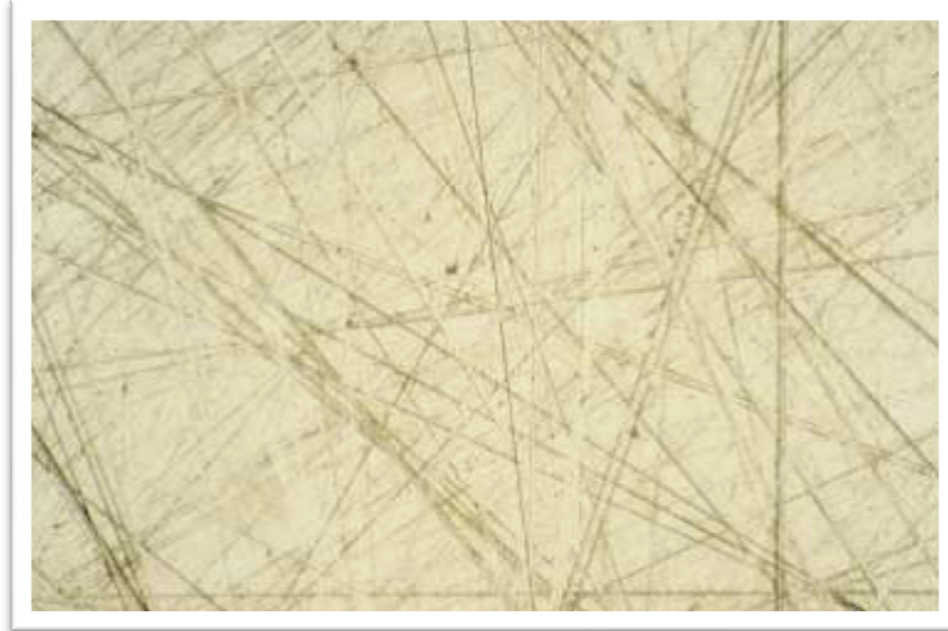
Aum 200 x. Rayas producidas tras el pulido fino. Metalog guide Struers
