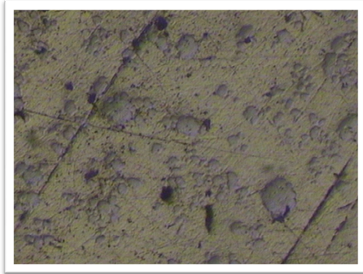
Figura 8.14 Defecto superficial donde se aprecian una serie de inclusiones en una muestra de Ag-Pd. 600x
