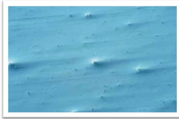
Aum 200x. Colas de cometa. Metalog guide Struers
