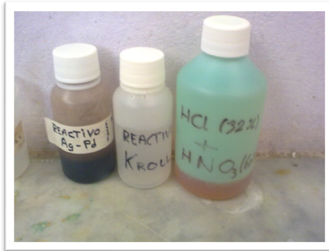
Figura 8.20 Reactivos de ataque tras su elaboración y preparados para su utilización en las muestras.
