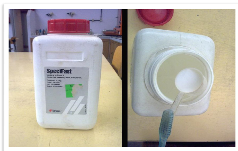
Figura 8.3 Resina de montaje utilizada en el taller para el encapsulamiento de nuestras muestras. Struers
