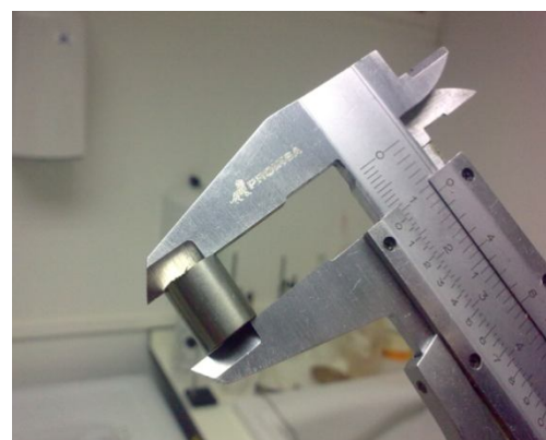
Figura 8.2 Medición de una muestra tras el corte en la sierra de precisión.
