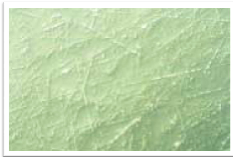
Aum 200x. Líneas de deformación afiladas. Metalog guide Struers
