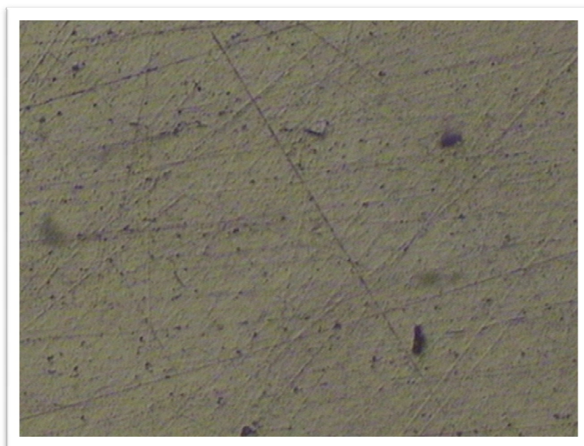
Figura 8.15 Defectos superficiales en una muestra de Ag-Pd de partículas abrasivas tras el lapeado 600x
