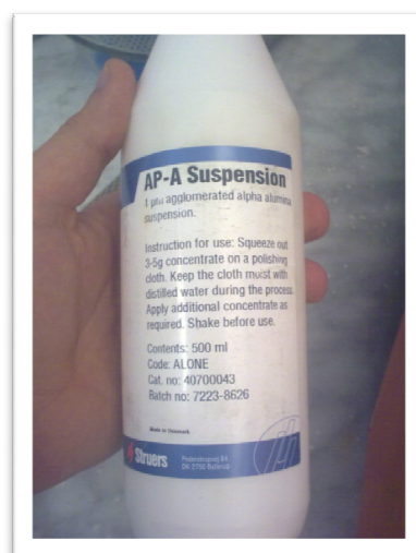
Figura 8.9 Abrasivo utilizado para el pulido manual en el taller. La fotografía corresponde a una pasta en suspensión de alúmina. Struers
