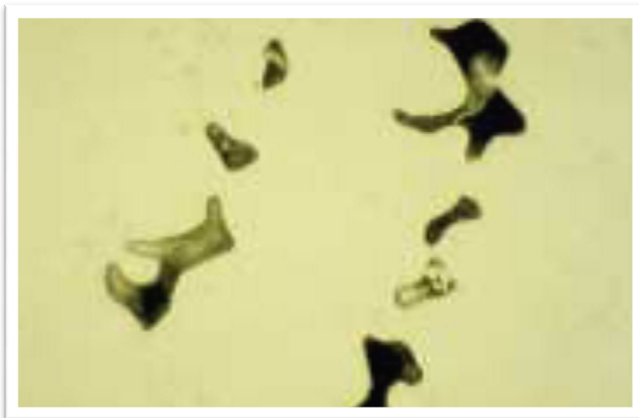
Aum 500 x. Superaleación después de 5 minutos de pulido. Metalog guide Struers
