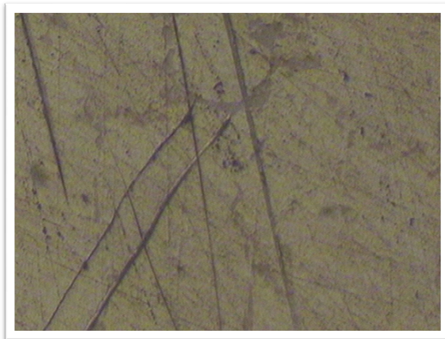
Figura 8.12 Defectos superficiales. Rayas de pulido correspondientes a una pieza de Ag-Pd. 600x
