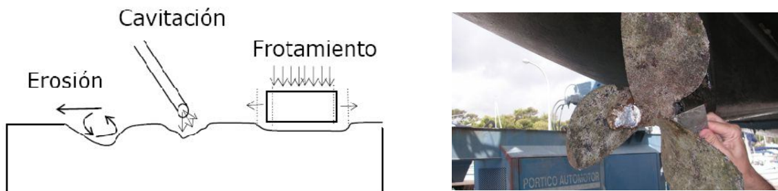
Figura 3.8 Representación gráfica de los tres tipos de corrosión erosiva. Se observa una hélice erosionada debida a la corrosión por cavitación producida.
