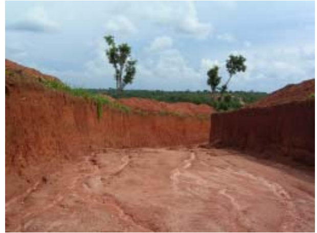
Figura 2.3.15. Corte efectuado en las exploraciones diamantíferas desarrolladas en paleoplaceres de la formación Calonda. Zona de Muanga (Angola).
