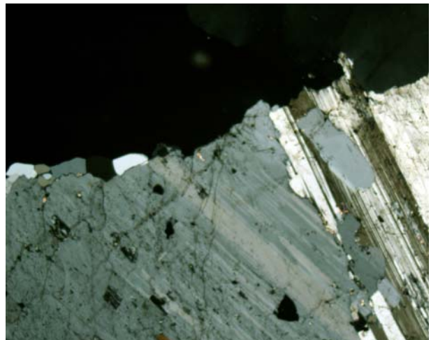
Figura 8.1.20. Albita en placas tardías reemplazando casi totalmente un cristal de microclina, del que quedan sólo relictos. Nícoles cruzados. Campo, 11,6 mm.
