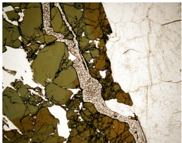
Figura 7.1.21. Detalle de la zonación de los márgenes de un cristal de turmalina de gran tamaño, asociado a microclina. Sin analizador. Campo, 11,6 mm.
