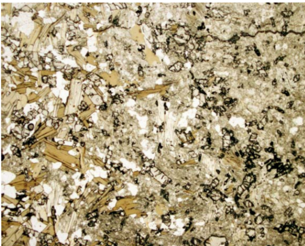
Figura 9.1.8. Detalle del reemplazamiento más interno en la zona de borde (ángulo superior derecho de la imagen) hacia el exocontacto (ángulo inferior izquierdo de la imagen). Nótese la desaparición de la biotita y del cuarzo en la zona de borde. Sin analizador. Campo, 11.6 mm.
