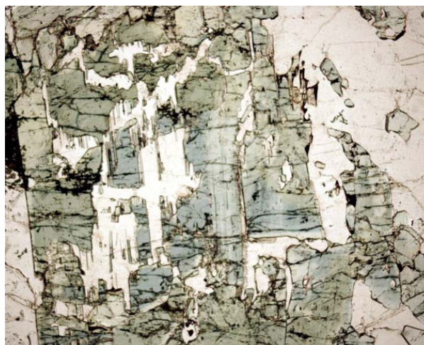
Figura 9.1.20. Zonado en cristales esqueléticos de turmalina. Sin analizador. Campo, 11,6 mm..
