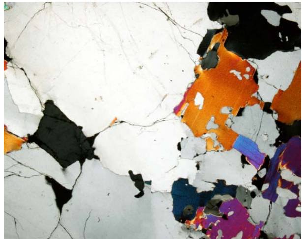
Figura 7.1.12. La imagen anterior en nícoles cruzados; la moscovita presenta colores de interferencia elevados; nótese extinción ondulante en el cuarzo.
