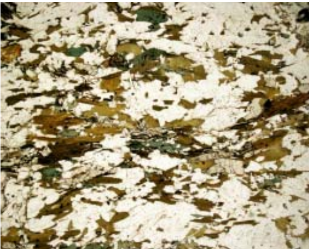
Figura 3.1.23. Detalle al microscopio de luz transmitida (sin analizador) de una metatufita, con plagioclasa, anfíbol (verde), biotita (marrón) y cuarzo. Campo, 5,8 mm.
