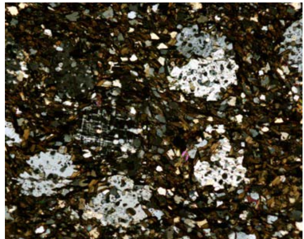
Figura 3.1.44. Detalle al microscopio de luz transmitida (en nícoles cruzados) de la misma imagen anterior. A destacar el maclado en la cordierita.
