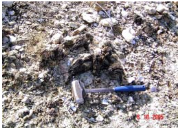
Figura 9.1.5. Cristales hipidiomórficos de moscovita de grandes dimensiones en la zona de borde de la pegmatita de tipo V.
