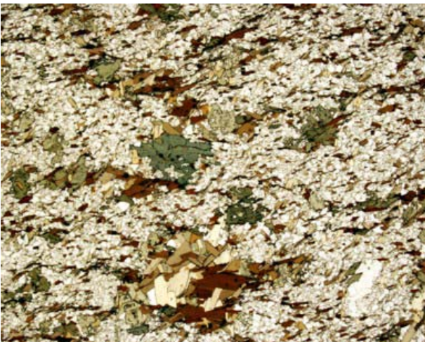
Figura 3.1.25. Detalle al microscopio de luz transmitida (sin analizador) de una metatufita, con plagioclasa, anfíbol (verde), biotita (marrón) y cuarzo. Campo, 5,8 mm.
