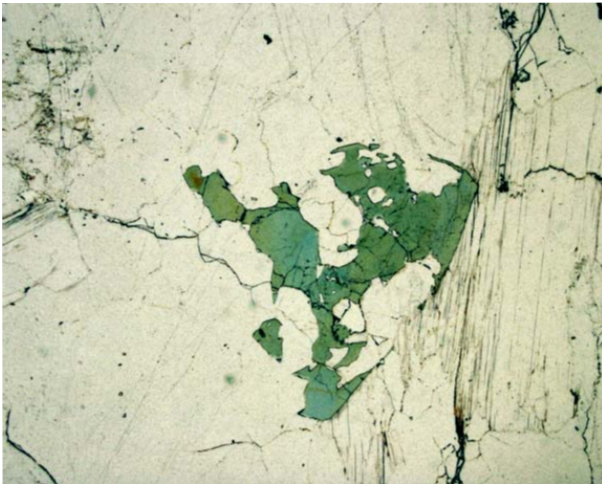
Figura 9.1.17. Cristal esquelético de turmalina entre cuarzo; a la derecha se aprecia un cristal de moscovita. Sin analizador. Campo, 11.6 mm.
