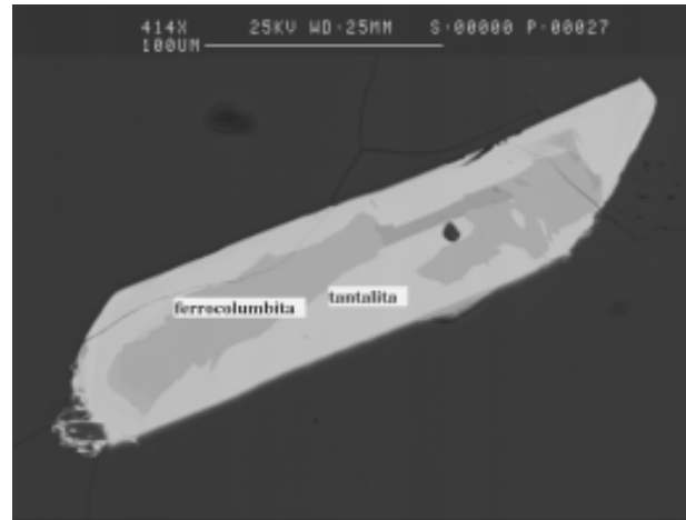
Figura 8.1.81. Cristal tabular de columbita en la segunda zona intermedia, con zonado reemplazante normal (núcleo rico en Nb, oscuro) y periferia rica en Ta (clara). Imagen de SEM, modo BSE.
