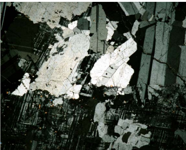
Figura 8.1.112. Detalle del contacto reemplazante de una veta de albitita con microclina de la tercera zona intermedia. Nícoles cruzados. Campo, 11,6 mm.
