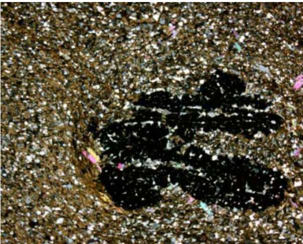
Figura 3.1.41. Detalle al microscopio de luz transmitida (nícoles cruzados) de un esquistó, con almandino rotado, cuarzo y biotita (marrón). Campo, 4,8 mm.
