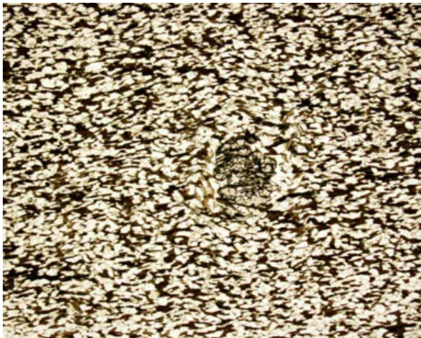
Figura 3.1.35. Detalle al microscopio de luz transmitida (sin analizador) de una esquistosilíceo, con almandino (alto relieve), cuarzo (bajo relieve, incoloro) y biotita (marrón). Campo, 11,6 mm.
