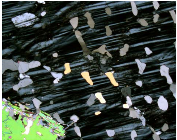
Figura 8.1.18. Intercrecimientos gráficos entre cuarzo y microclina en la primera zona intermedia; se distinguen pertitas en la microclina. Nícoles cruzados. Campo, 11,6 mm..
