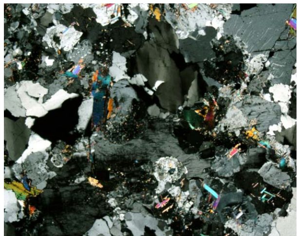
Figura 3.1.83. Otro detalle de la asociación con moscovita; se aprecian cristales de plagioclasa zonada dentro de los cristales de microclina. Nícoles cruzados. Campo, 11,6 mm.
