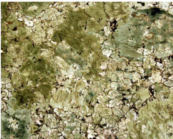
Figura 3.1.47. Detalle al microscopio de luz transmitida (sin analizador) de una piroxenita, con piroxeno (incoloro) y anfíbol (verde, zonado). Campo, 5,8 mm.
