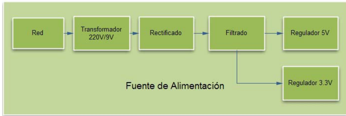
Fig. 45 Diagrama funcional de bloques de la Fuente de Alimentación.
